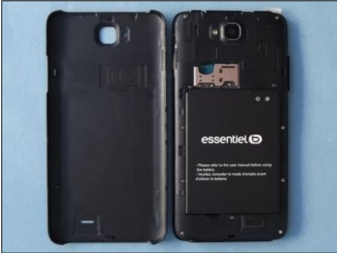
Photo 5: EST – vue arrière (ouvert) avec batterie
