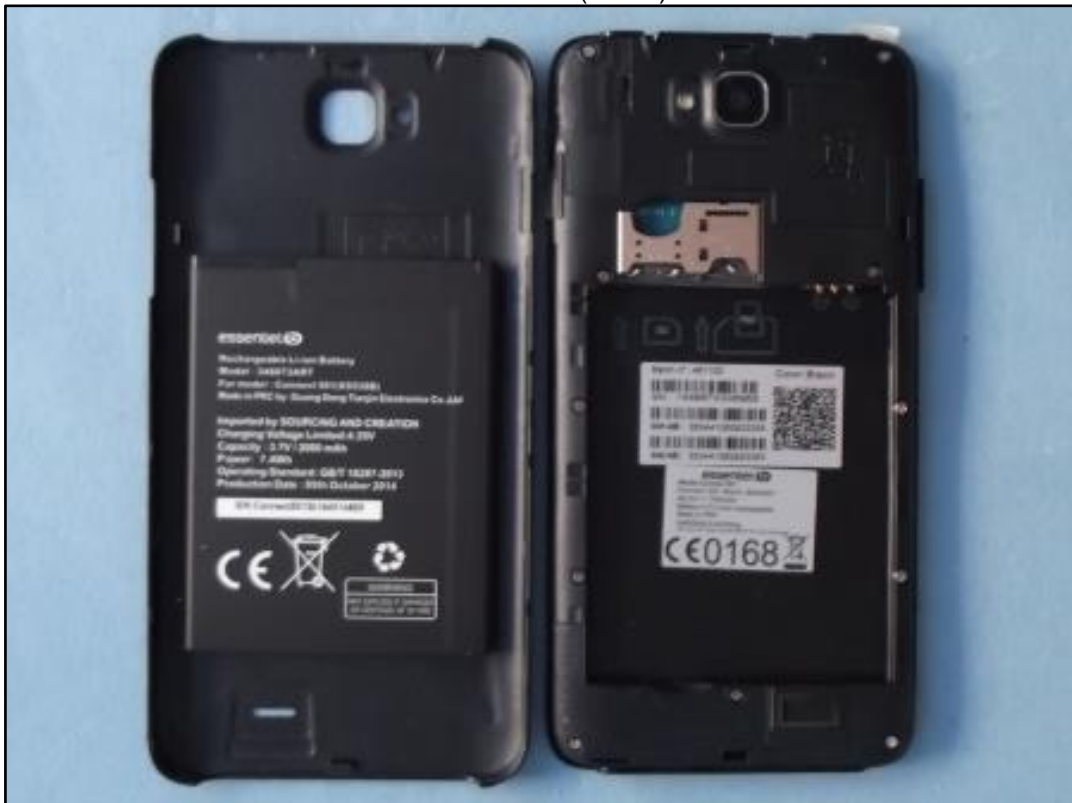
Photo 6: EST – vue arrière (ouvert) sans batterie
