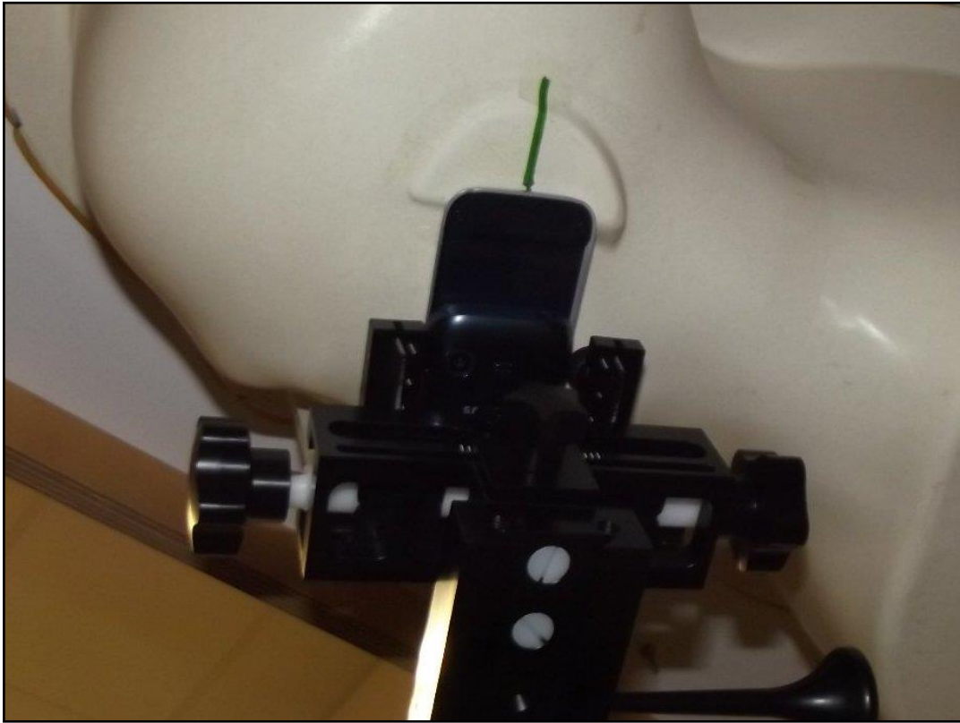
Photo 22: Position d'essai main gauche, incliné 15° (glissière ouverte)
