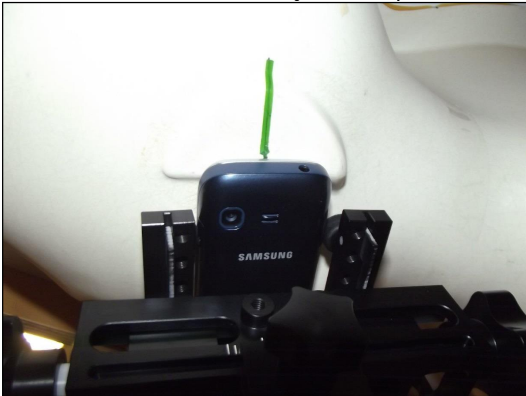
Photo 12: Position d'essai main gauche, incliné 15°
