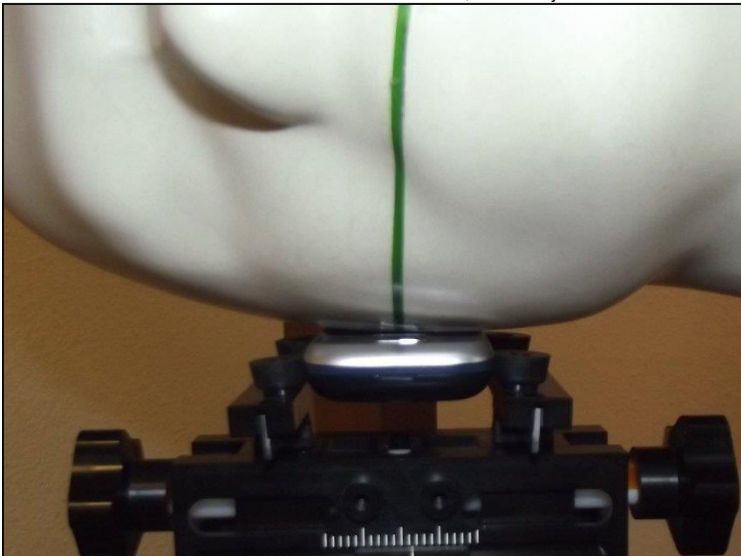
Photo 14: Position d'essai main droite, contre la joue
