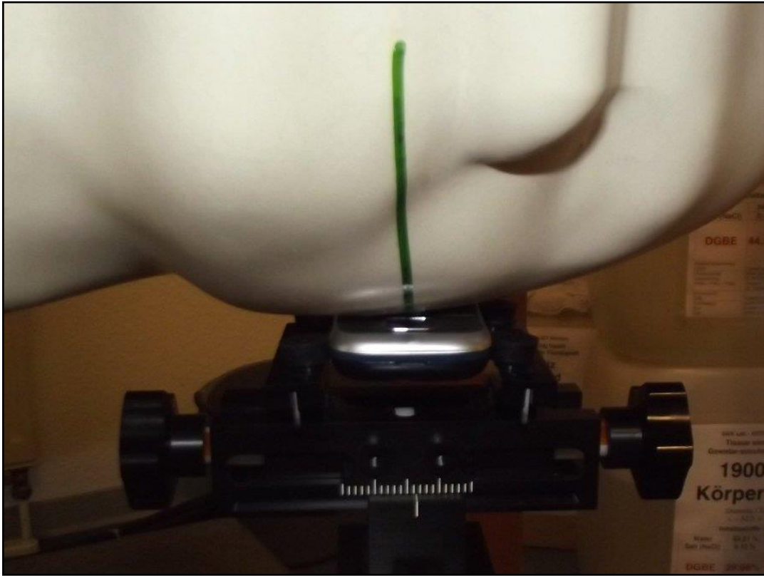
Photo 10: Position d'essai main gauche, contre la joue
