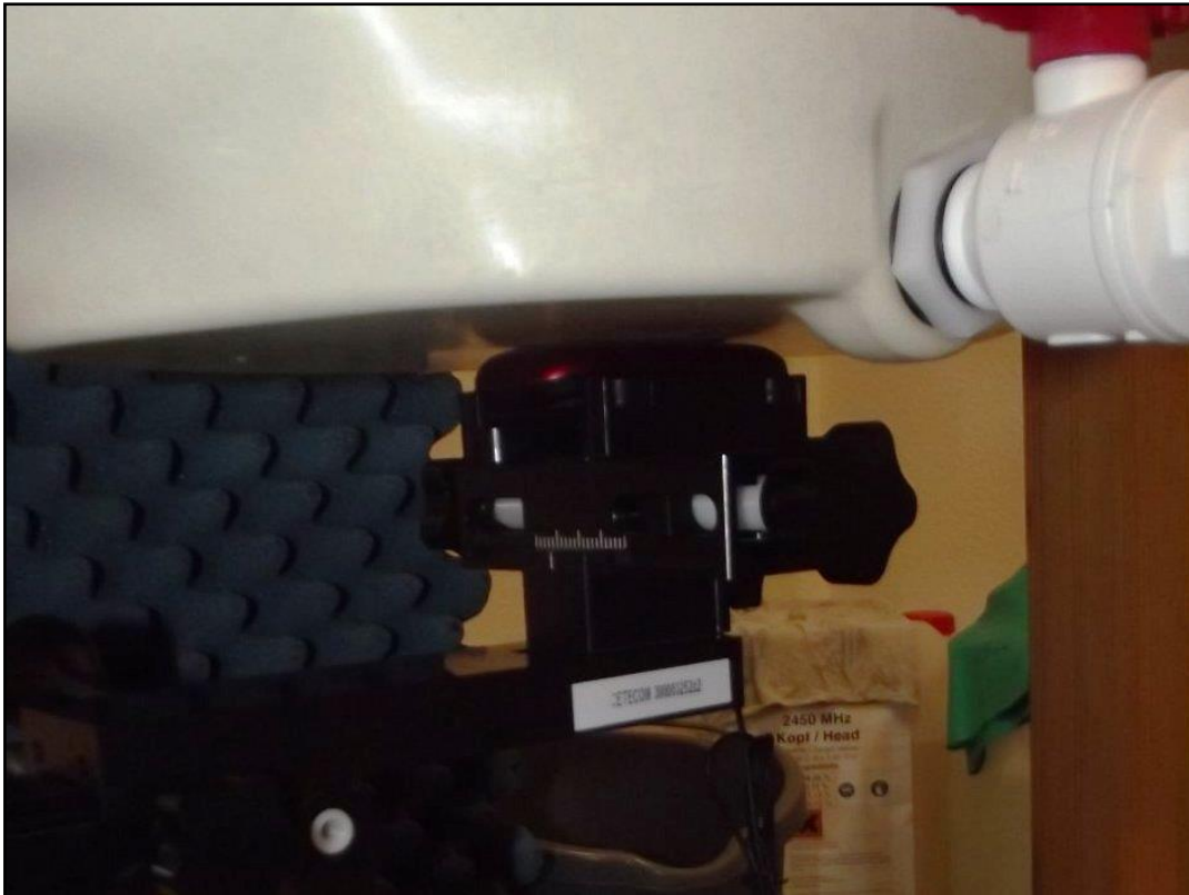
Photo 11: Position d'essai face arrière contre le corps (distance 0 mm)
