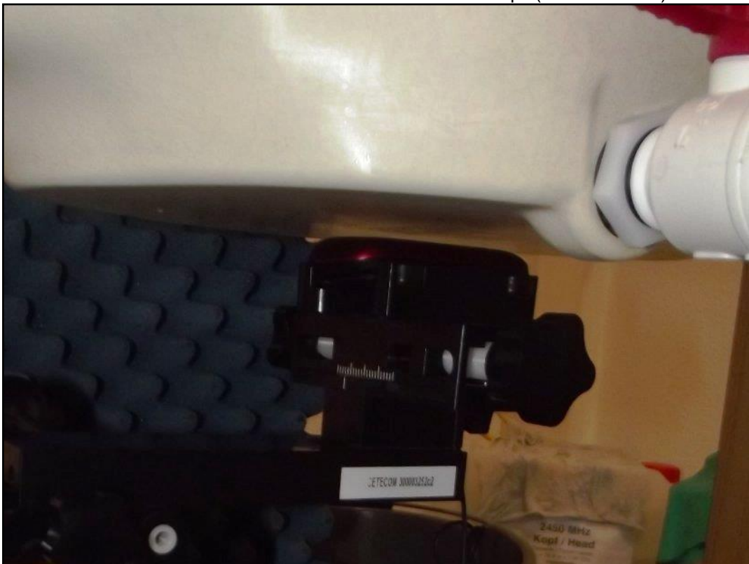
Photo 12: Position d'essai face arrière contre le corps (distance 5 mm)
