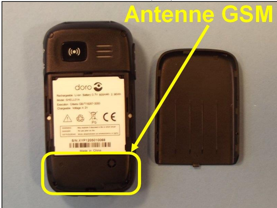
Photo 5: EST – vue arrière (ouvert) avec batterie
