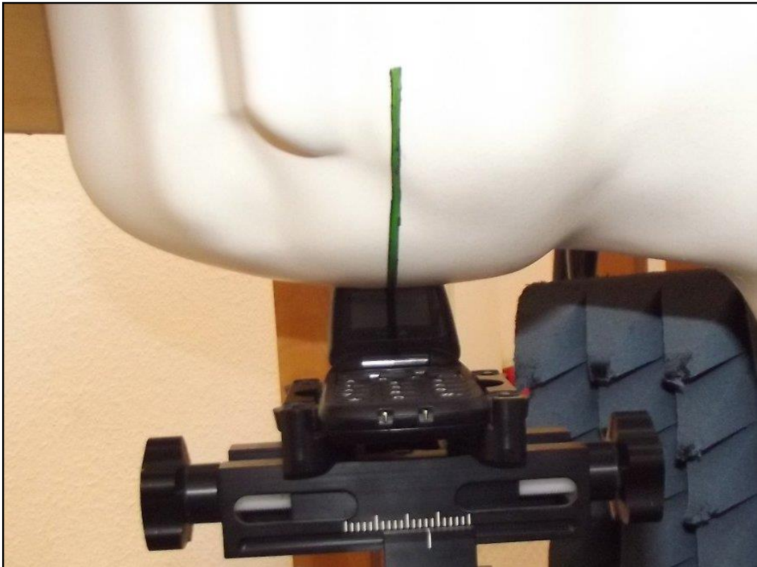
Photo 16: Position d'essai main droite, incliné 15°
