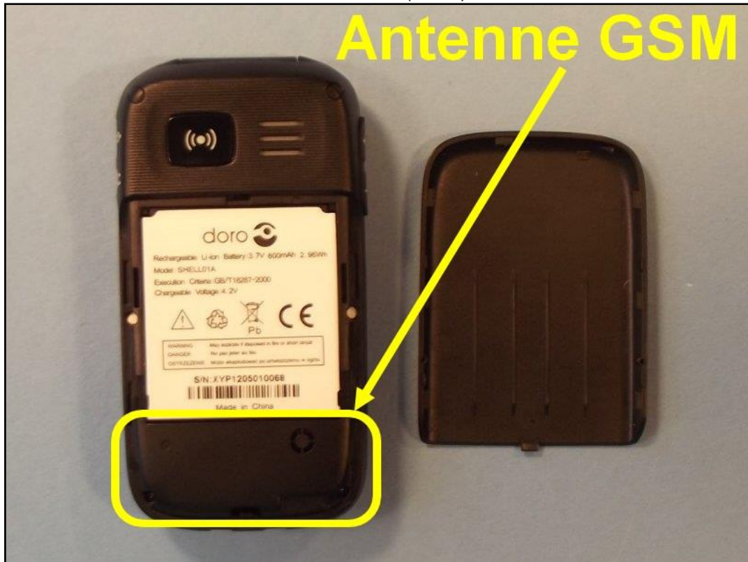
Photo 5: EST – vue arrière (ouvert) avec batterie
