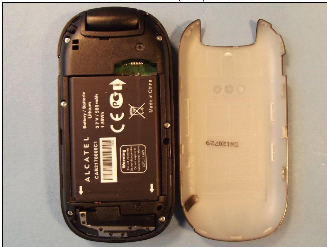
Photo 6: EST – vue arrière (ouvert) avec batterie
