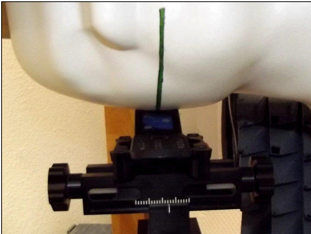
Photo 18: Position d'essai main droite, incliné 15°
