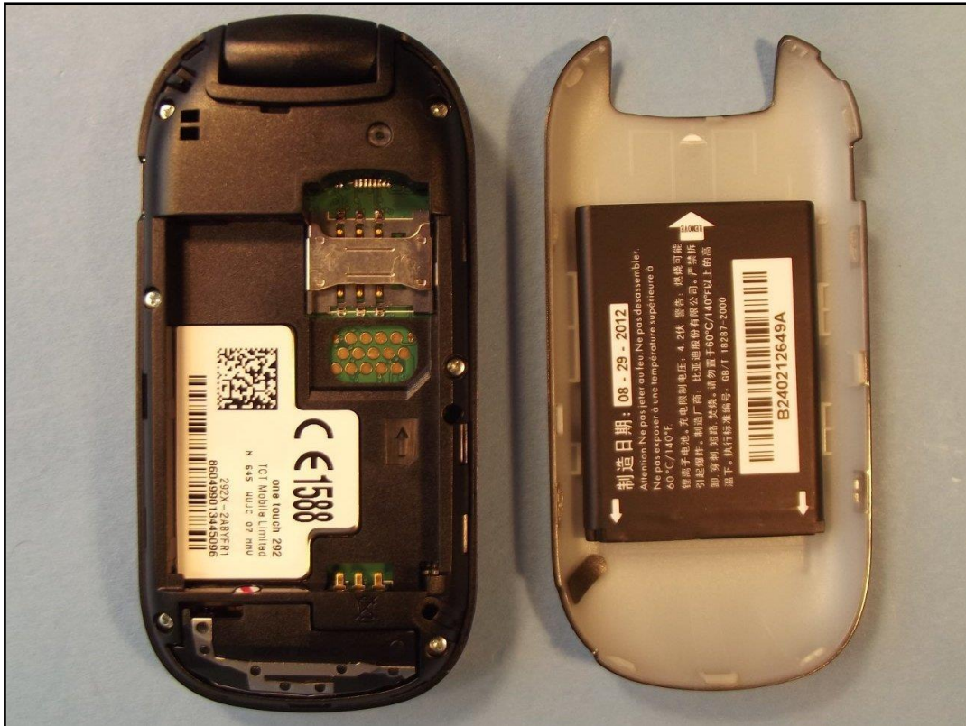
Photo 7: EST – vue arrière (ouvert) sans batterie
