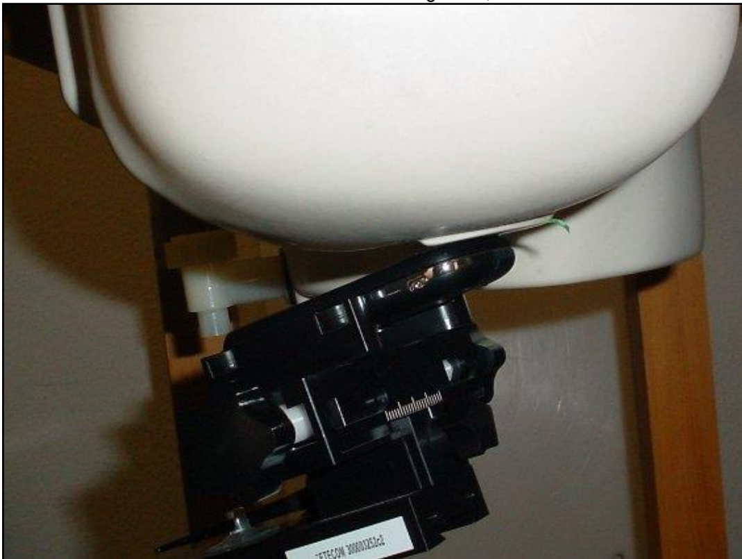
Photo 14: Position d'essai main gauche, incliné 15°
