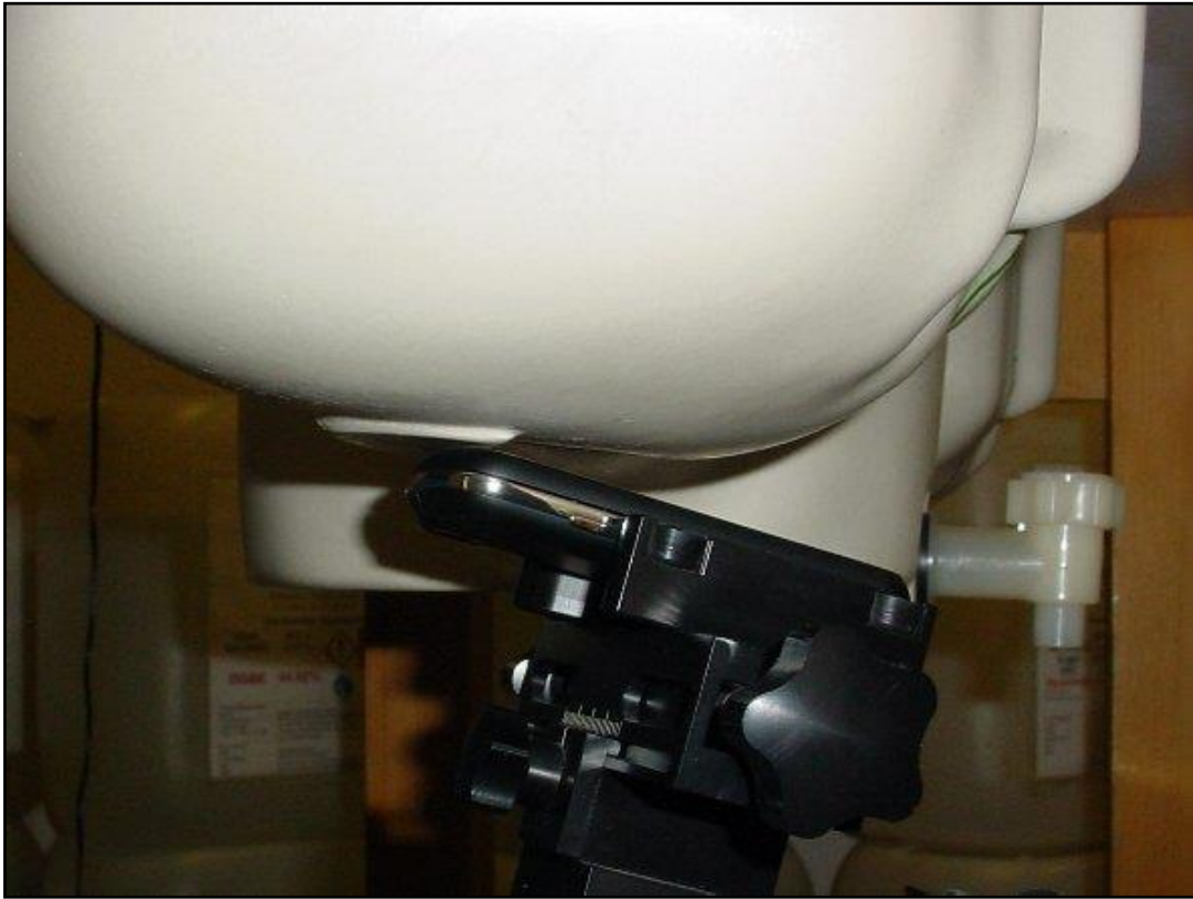
Photo 20: Position d'essai main gauche, contre la joue (glissière ouverte)
