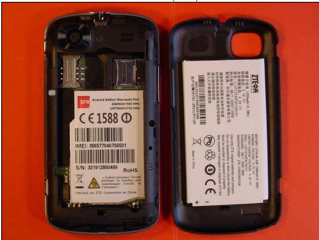
Photo 8: EST – vue arrière (ouvert) sans batterie
