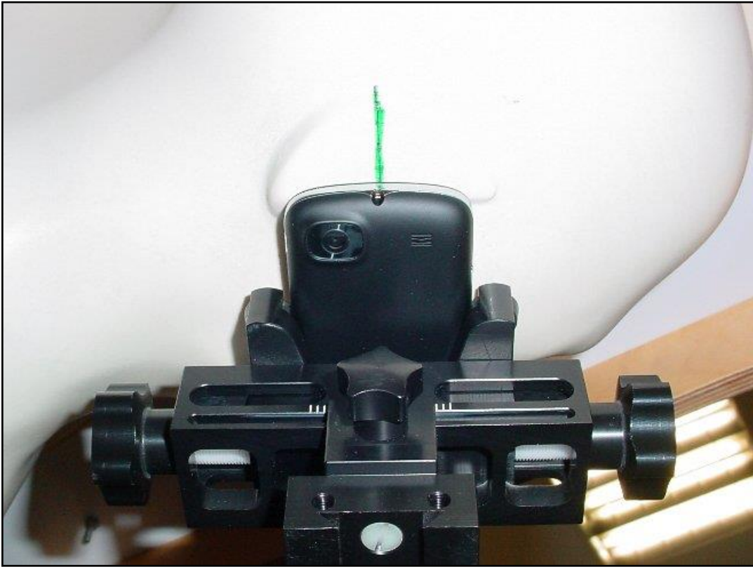
Photo 18: Position d'essai main droite, incliné 15°
