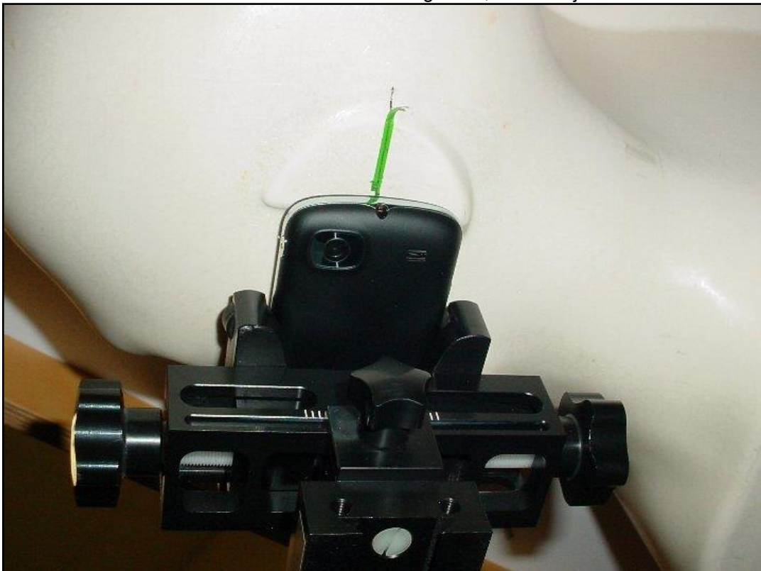
Photo 12: Position d'essai main gauche, contre la joue
