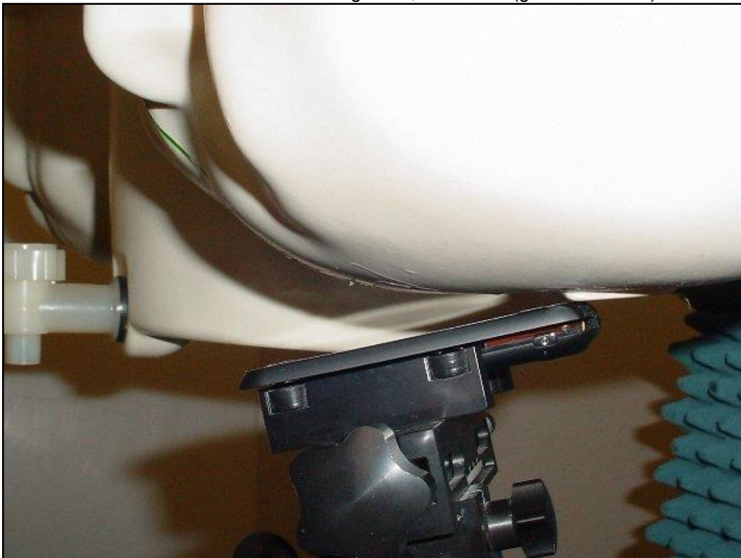
Photo 24: Position d'essai main gauche, incliné 15° (glissière ouverte)
