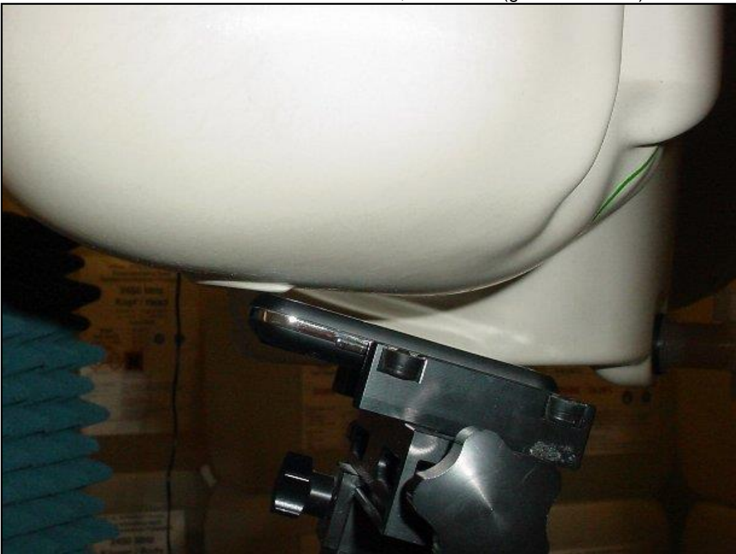
Photo 28: Position d'essai main droite, incliné 15° (glissière ouverte)
