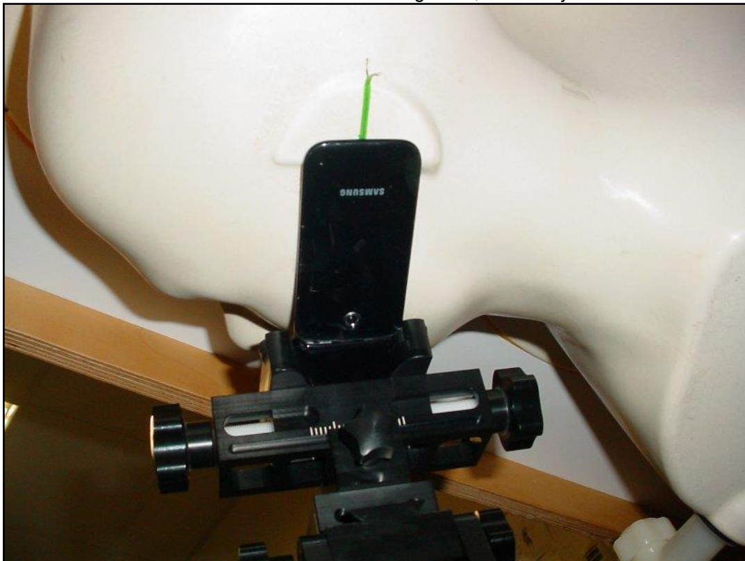
Photo 12: Position d'essai main gauche, contre la joue
