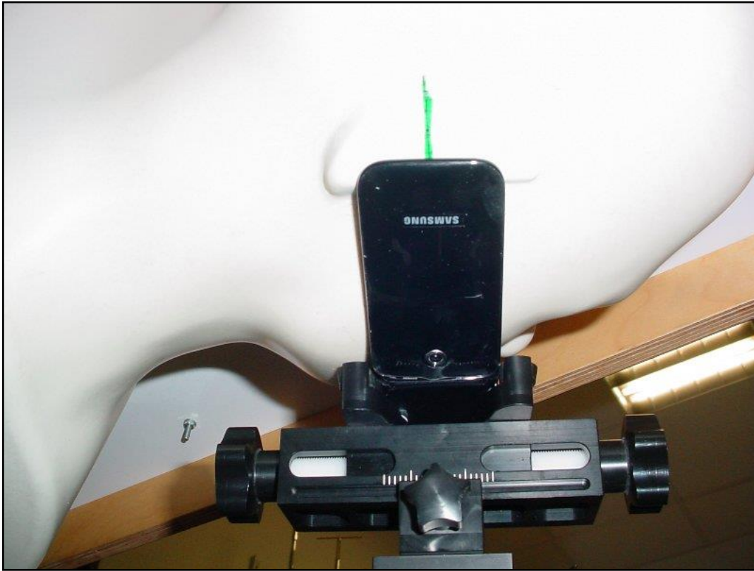
Photo 18: Position d'essai main droite, incliné 15°
