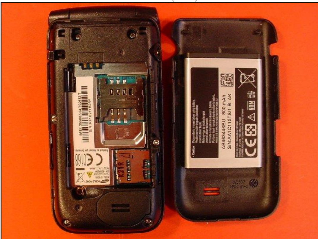
Photo 8: EST – vue arrière (ouvert) sans batterie
