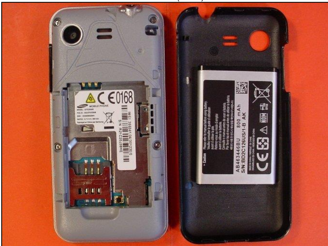
Photo 8: EST – vue arrière (ouvert) sans batterie
