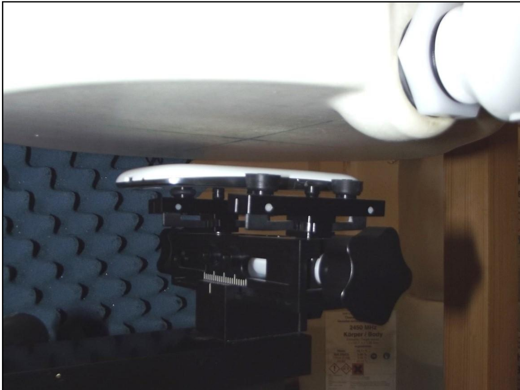
Photo 13: Position d'essai face arrière contre le corps (distance 15 mm)
