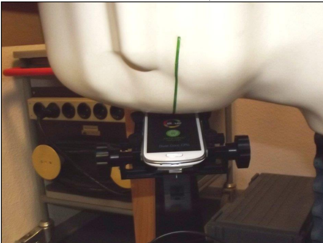
Photo 16: Position d'essai main droite, incliné 15°
