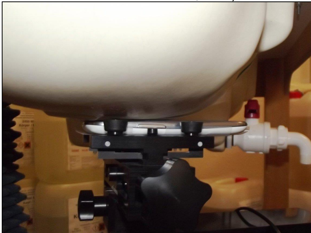
Photo 14: Position d'essai main droite, contre la joue
