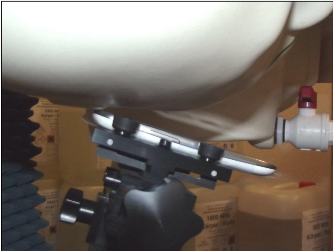
Photo 17: Position d'essai main droite, incliné 15°
