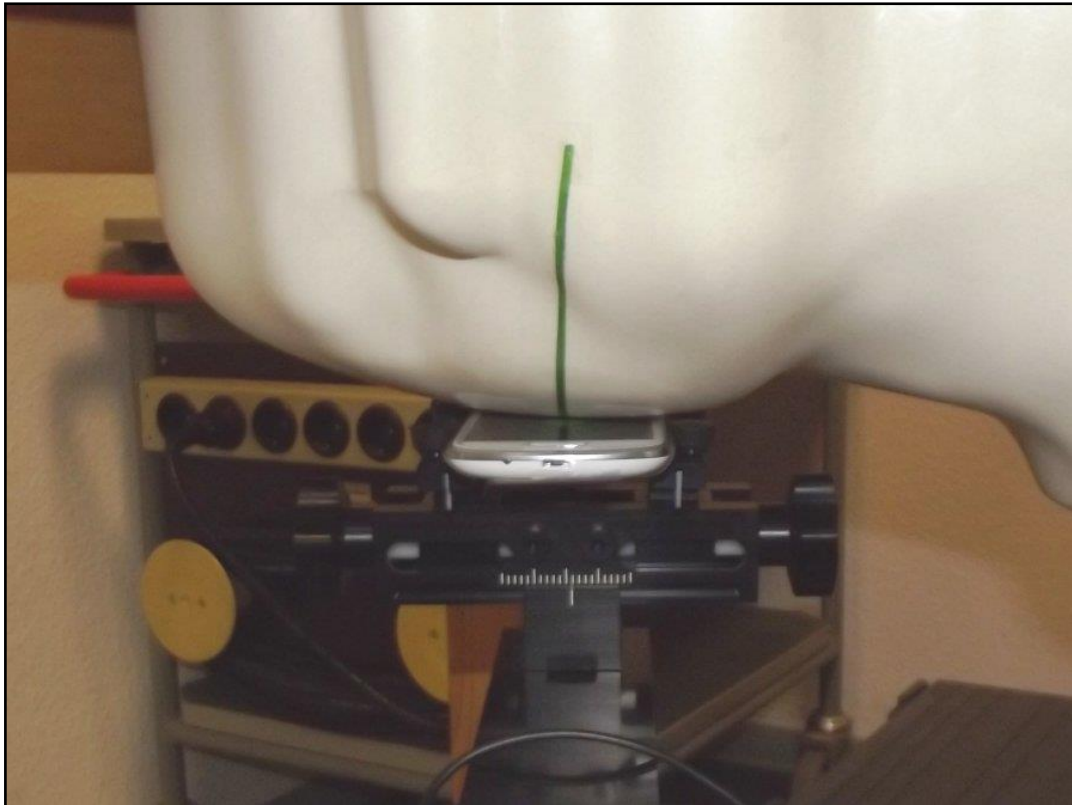
Photo 13: Position d'essai main droite, contre la joue
