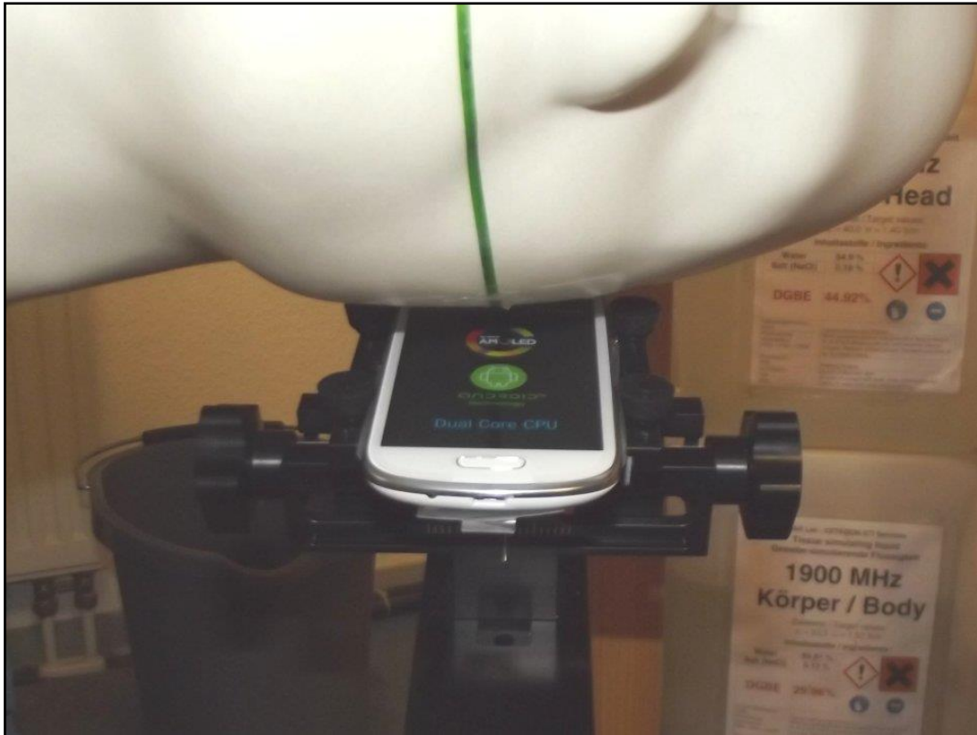
Photo 11: Position d'essai main gauche, incliné 15°
