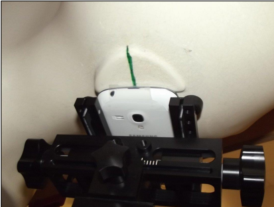
Photo 15: Position d'essai main droite, contre la joue
