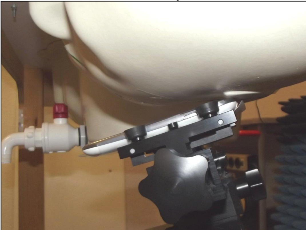
Photo 12: Position d'essai main gauche, incliné 15°
