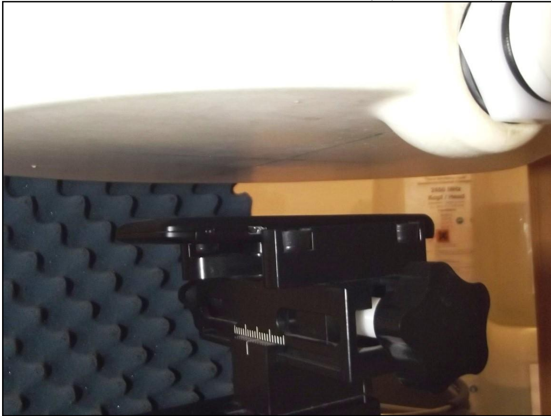
Photo 11: Position d'essai face arrière contre le corps (distance 25 mm)
