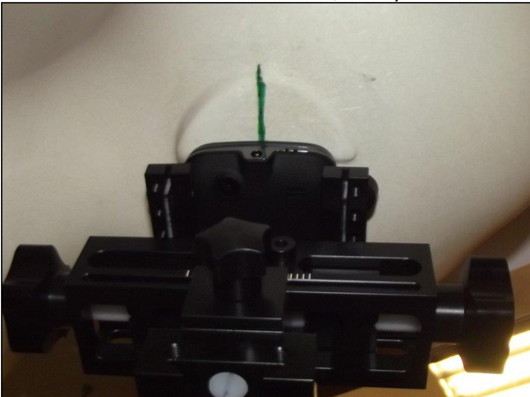
Photo 18: Position d'essai main droite, contre la joue
