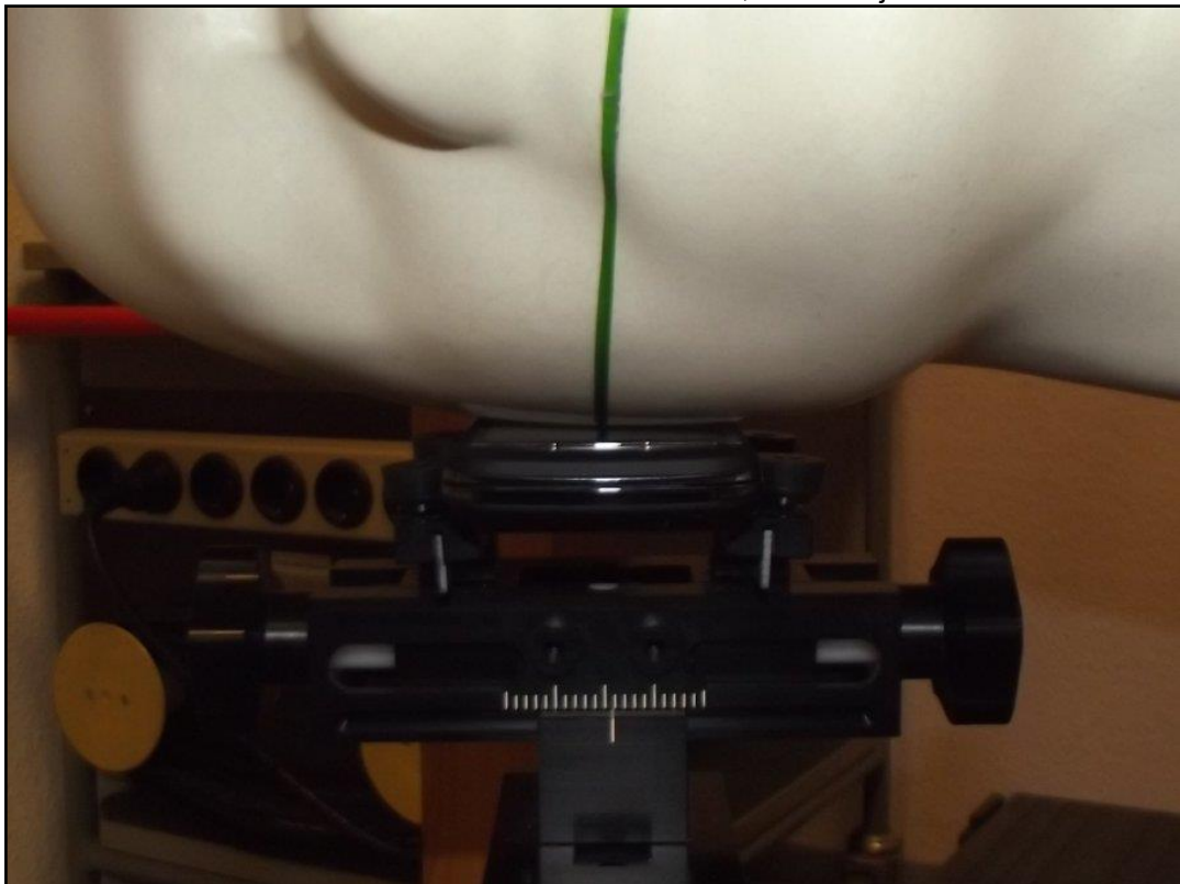
Photo 16: Position d'essai main droite, contre la joue
