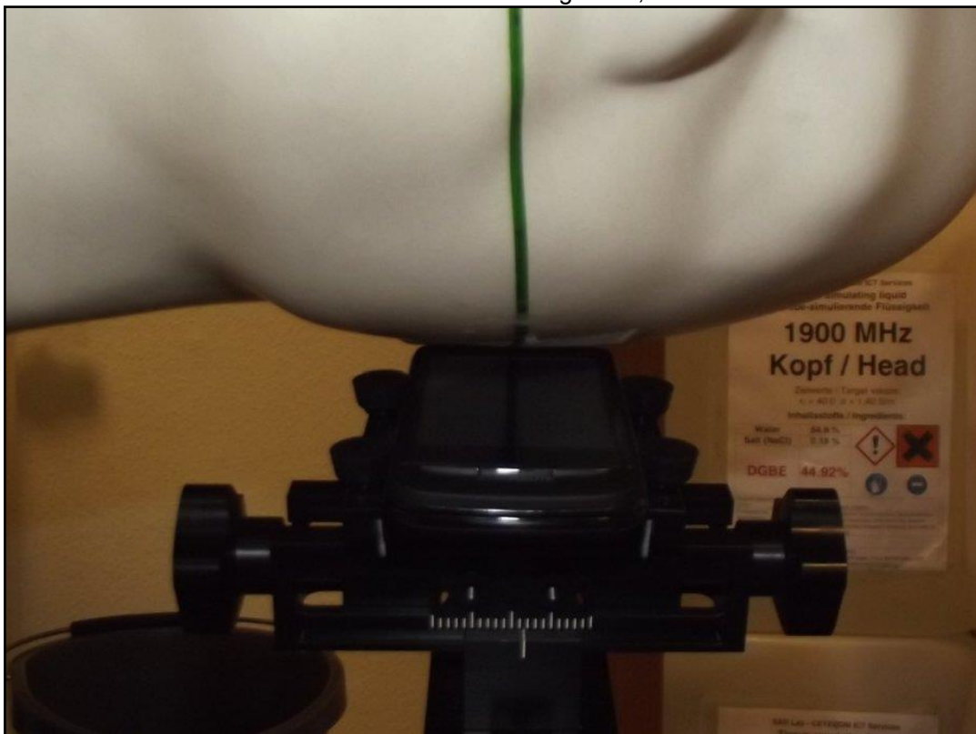
Photo 14: Position d'essai main gauche, incliné 15°
