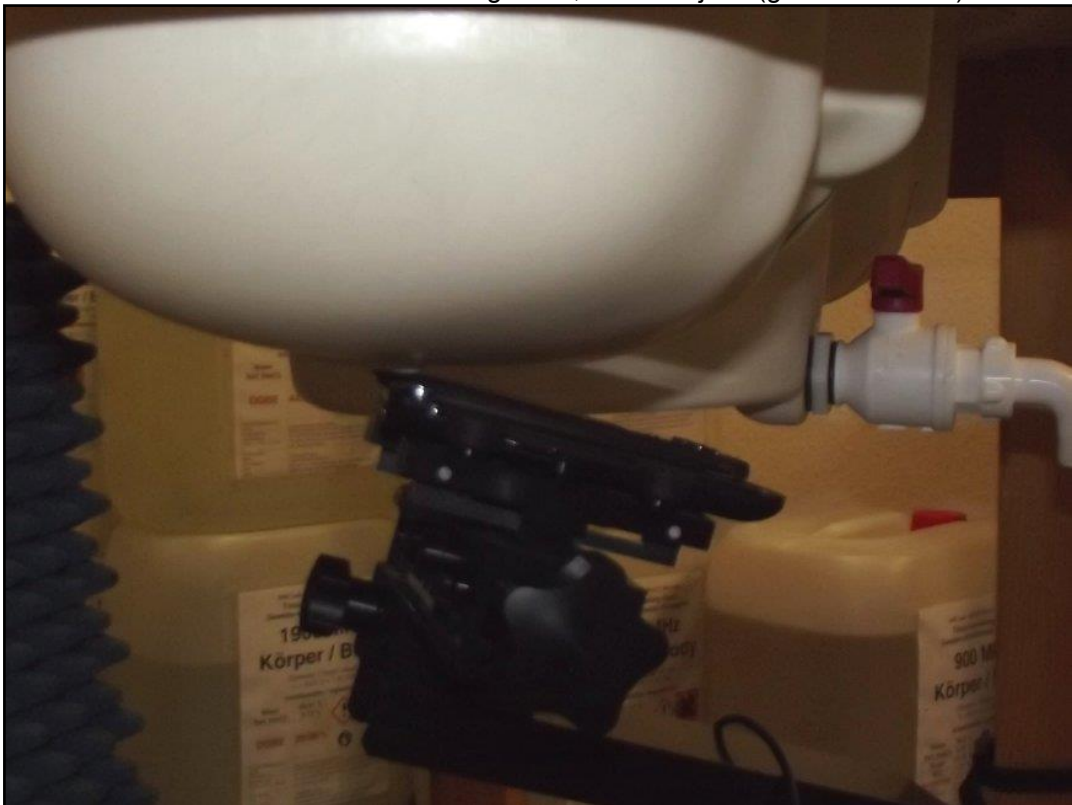
Photo 30: Position d'essai main gauche, contre la joue (glissière ouverte)
