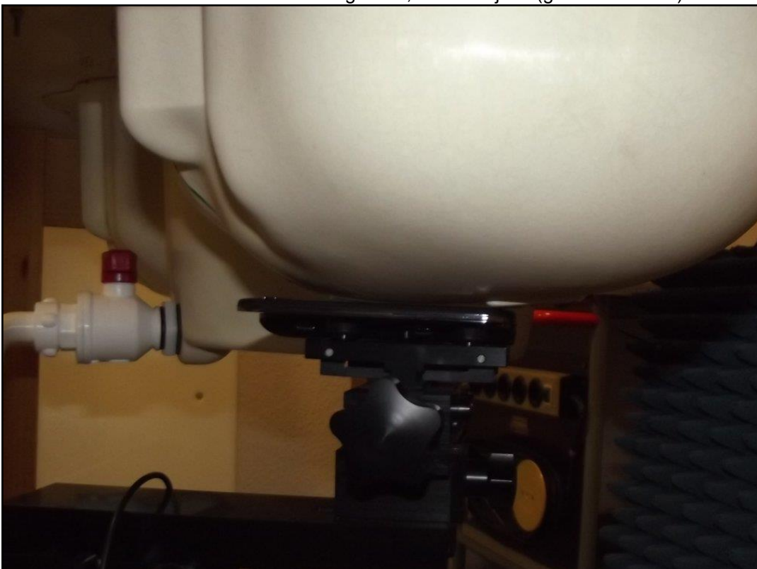
Photo 22: Position d'essai main gauche, contre la joue (glissière ouverte)
