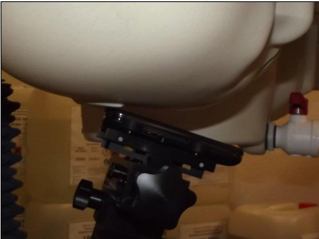
Photo 20: Position d'essai main droite, incliné 15°
