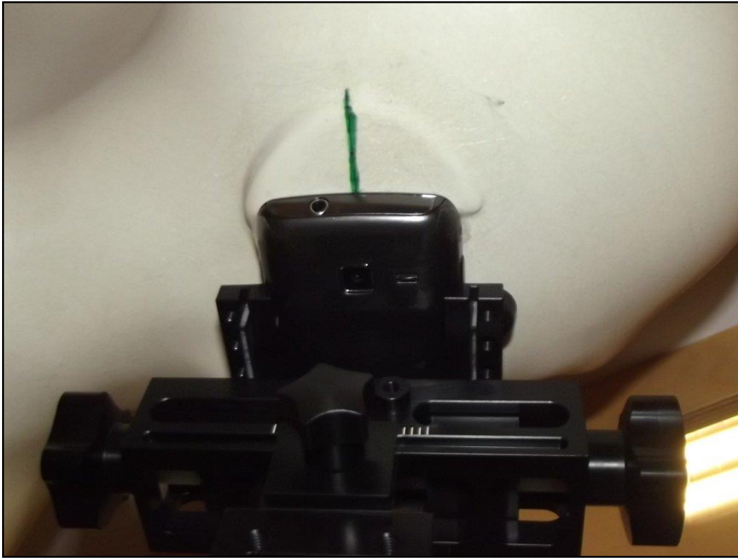
Photo 16: Position d'essai main droite, incliné 15°
