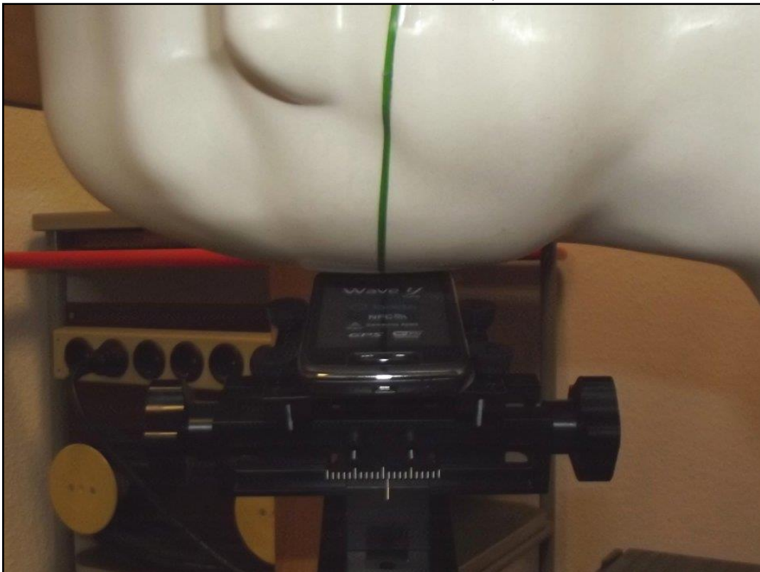
Photo 16: Position d'essai main droite, incliné 15°
