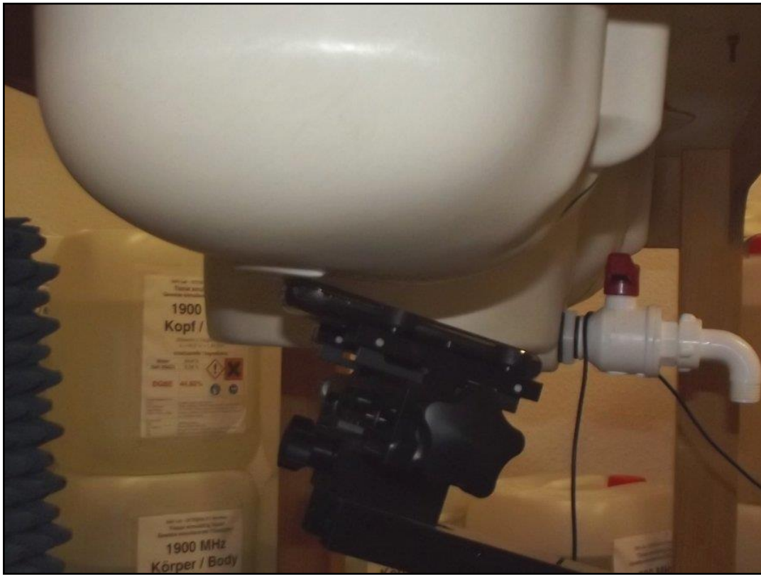
Photo 17: Position d'essai main droite, incliné 15°
