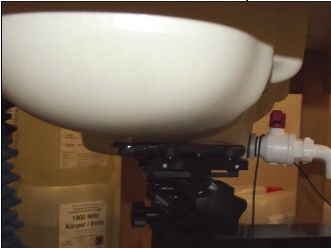
Photo 14: Position d'essai main droite, contre la joue
