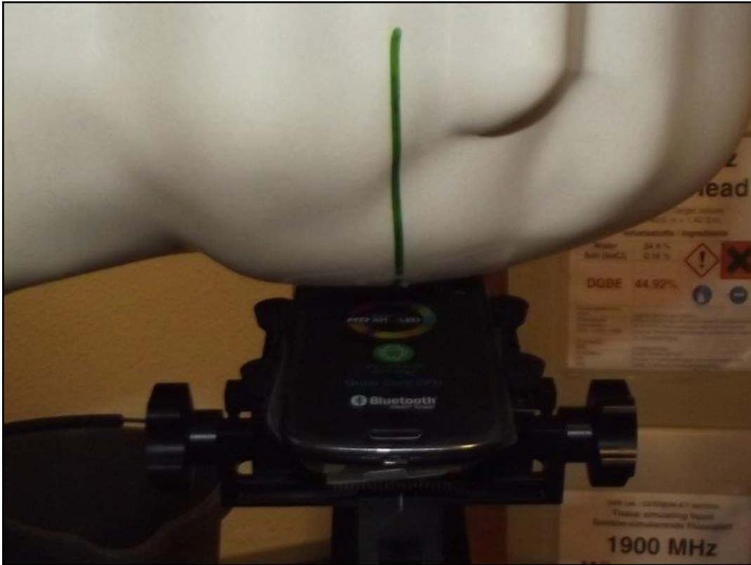
Photo 12: Position d'essai main gauche, incliné 15°
