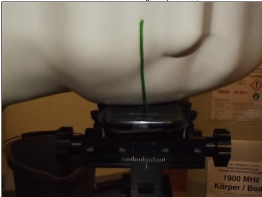
Photo 8: Position d'essai main gauche, contre la joue
