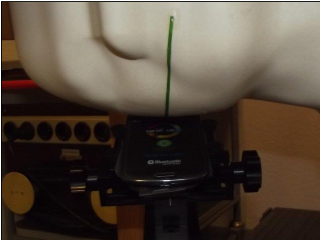
Photo 16: Position d'essai main droite, incliné 15°
