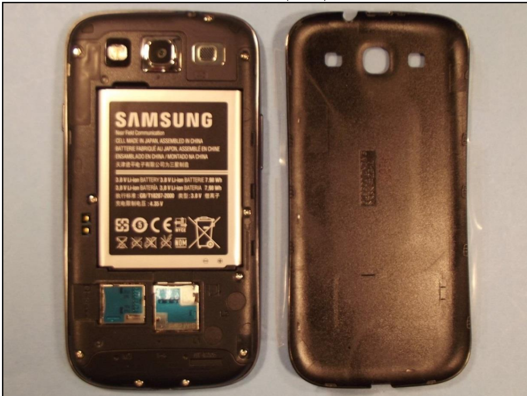
Photo 6: EST – vue arrière (ouvert) sans batterie
