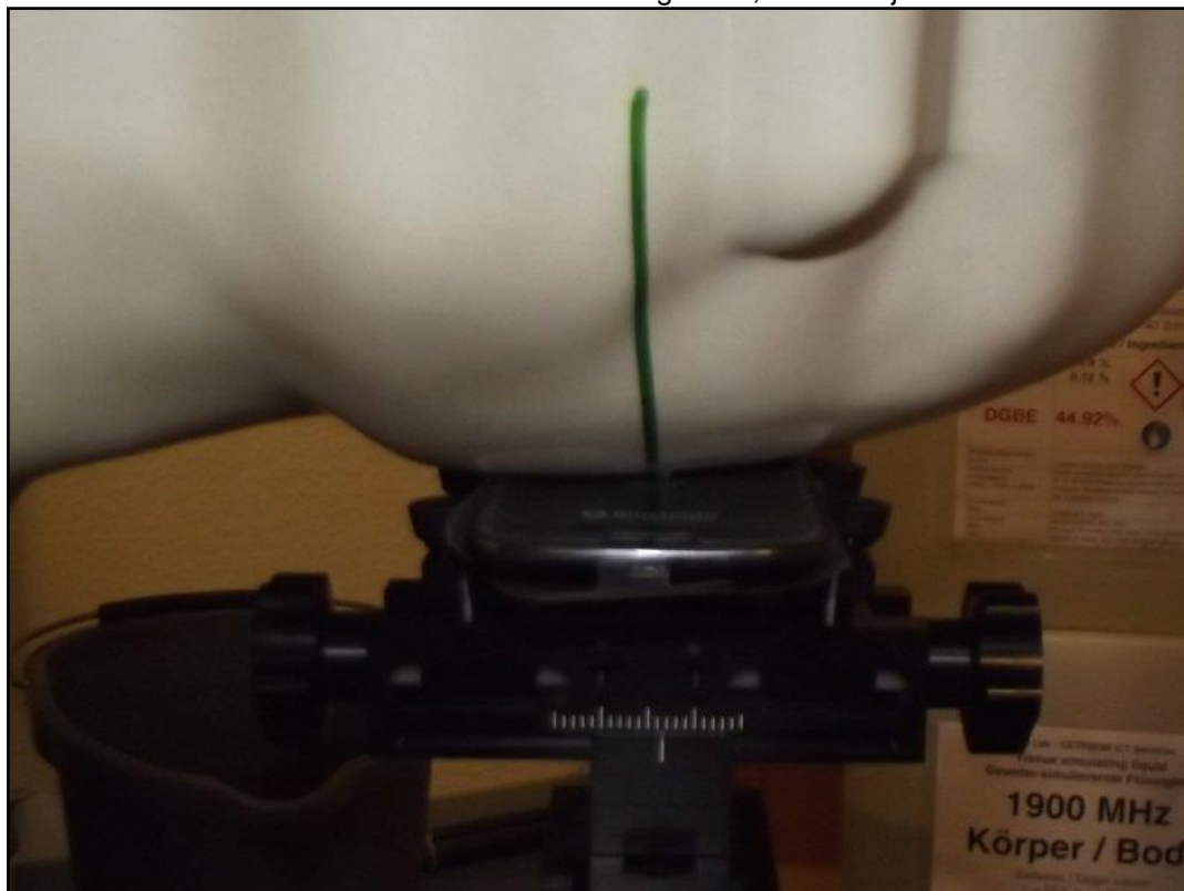
Photo 8: Position d'essai main gauche, contre la joue
