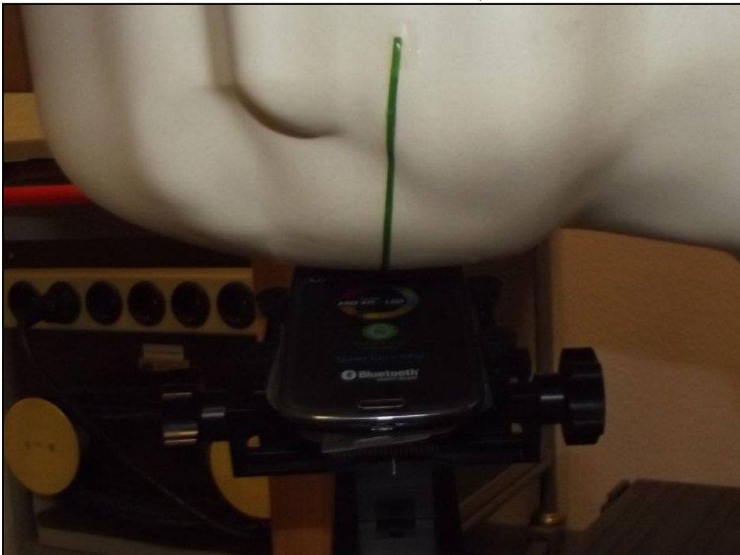
Photo 16: Position d'essai main droite, incliné 15°
