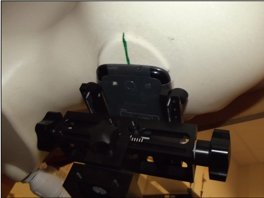
Photo 16: Position d'essai main droite, incliné 15°
