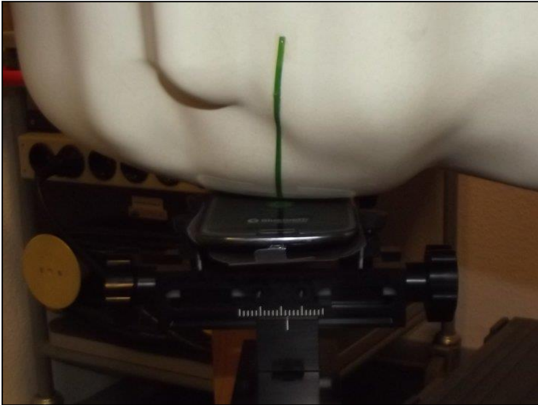
Photo 14: Position d'essai main droite, contre la joue
