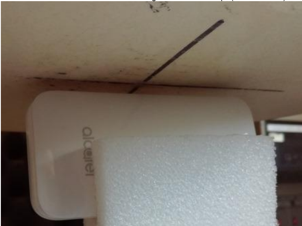
Photo 12: Position d'essai face du côté gauche contre le corps (distance 5 mm)
