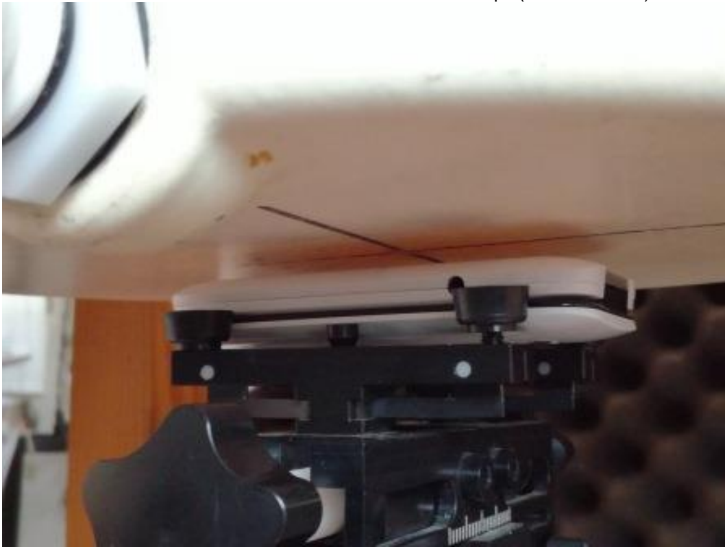
Photo 12: Position d'essai face du côté gauche contre le corps (distance 5 mm)
