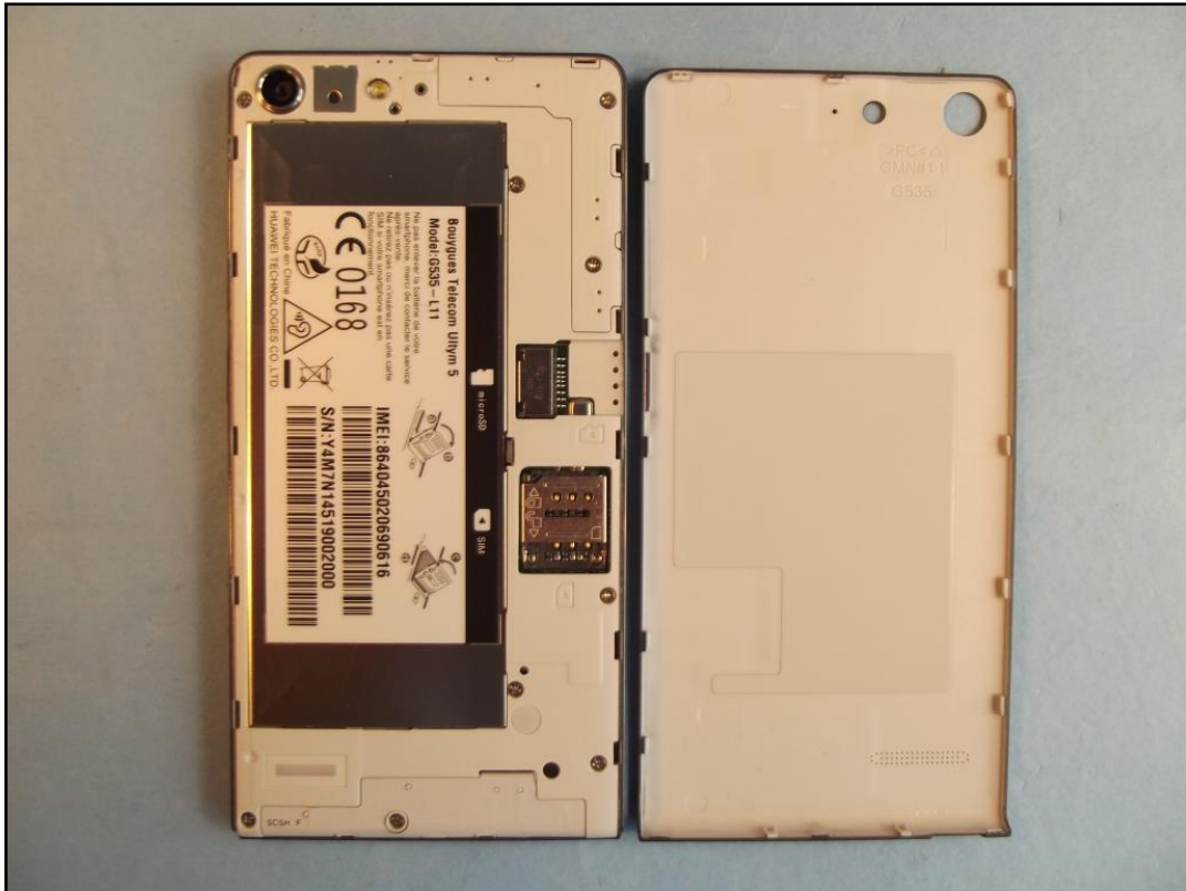
Photo 5: EST – vue arrière (ouvert) batterie intégrée _
