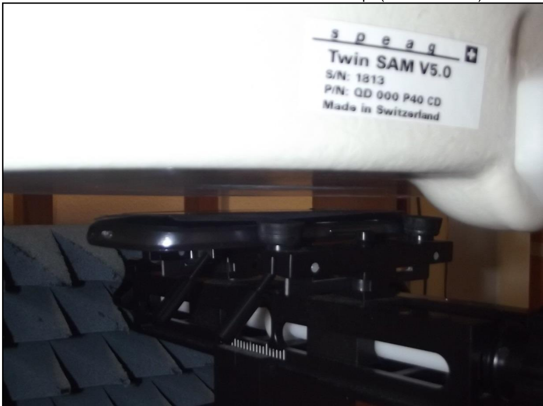
Photo 12: Position d'essai face avant contre le corps (distance 10 mm)
