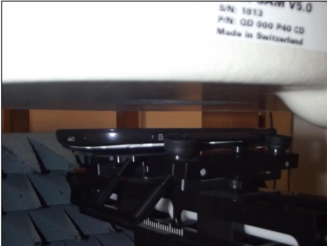
Photo 9: Position d'essai face avant contre le corps (distance 15 mm)
