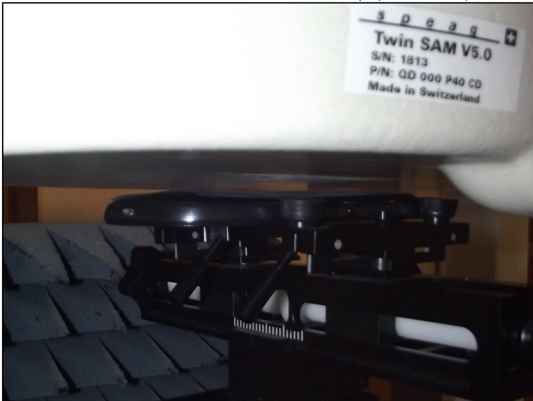
Photo 11: Position d'essai face avant contre le corps (distance 5 mm)
