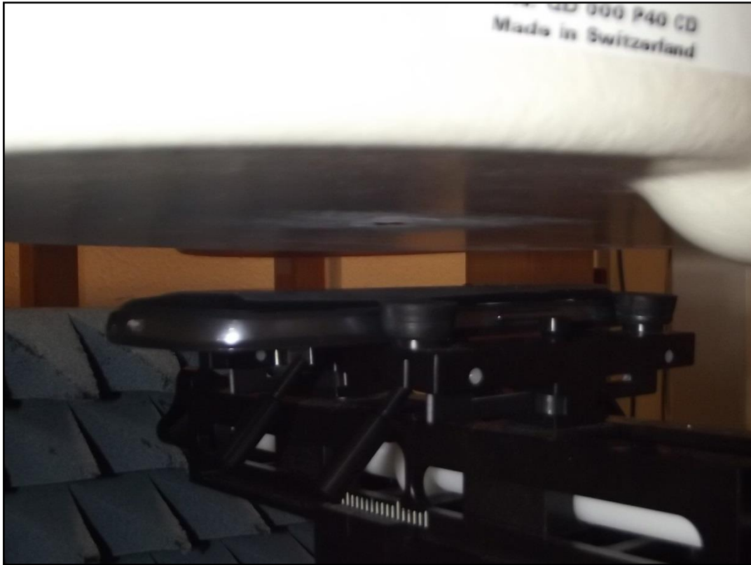
Photo 13: Position d'essai face avant contre le corps (distance 15 mm)
