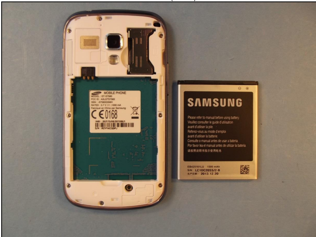
Photo 6: EST – vue arrière (ouvert) sans batterie
