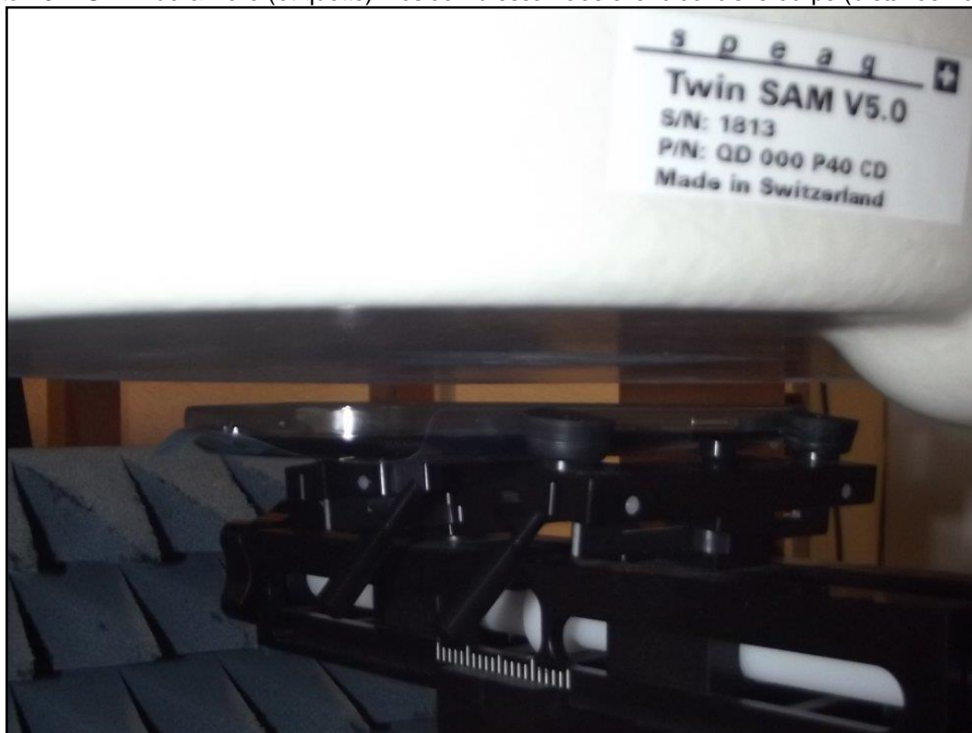
Photo 10: EST – vue arrière (étiquette) Position d'essai face avant contre le corps (distance 10 mm)
