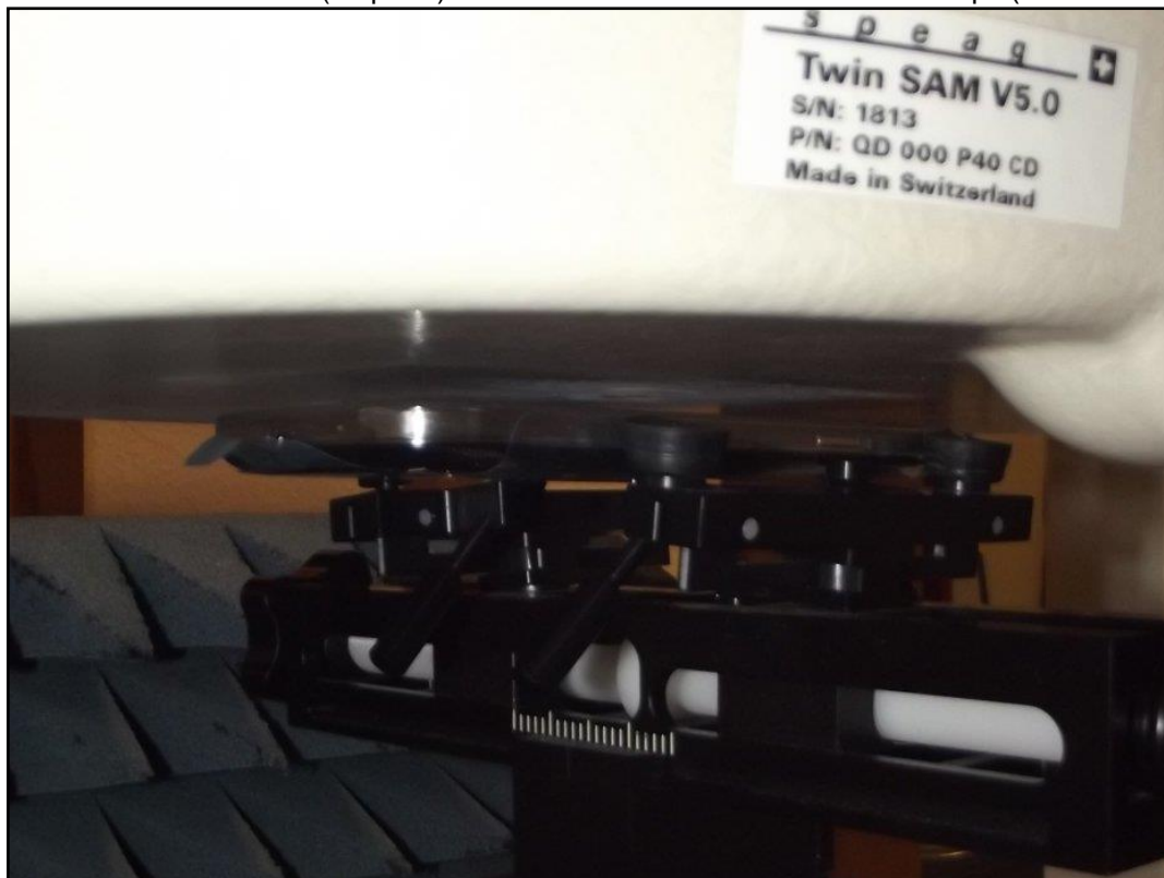
Photo 9: EST – vue arrière (étiquette) Position d'essai face avant contre le corps (distance 5 mm)
