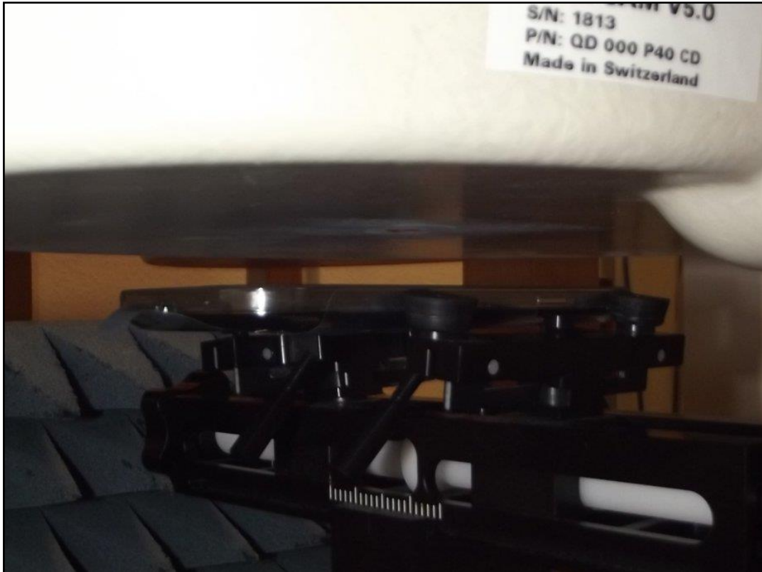
Photo 11: EST – vue arrière (étiquette) Position d'essai face avant contre le corps (distance 15 mm)
