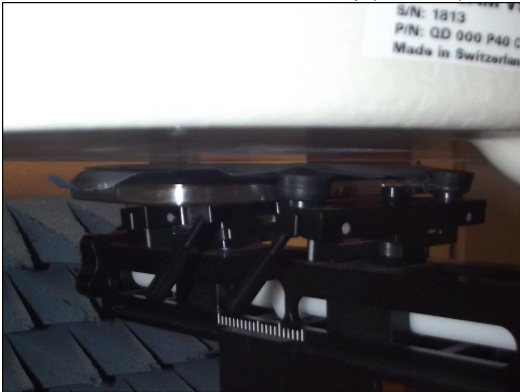
Photo 14: Position d'essai face arrière contre le corps (distance 10 mm)
