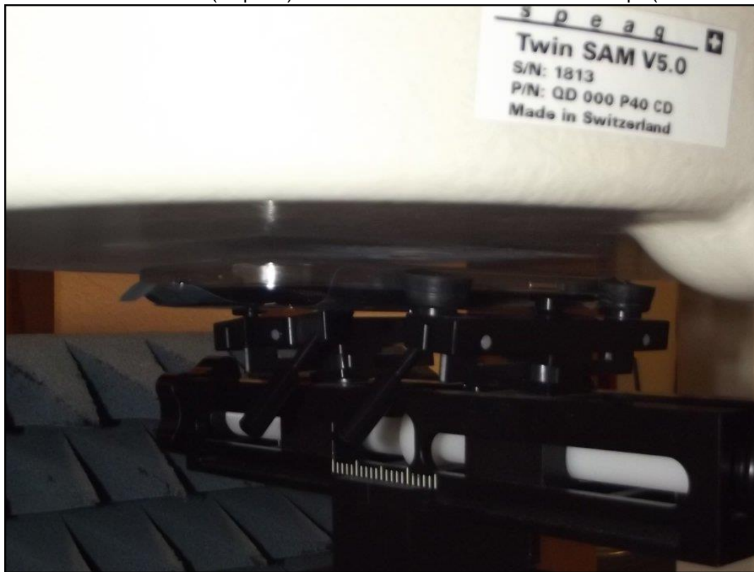
Photo 10: EST – vue arrière (étiquette) Position d'essai face avant contre le corps (distance 10 mm)
