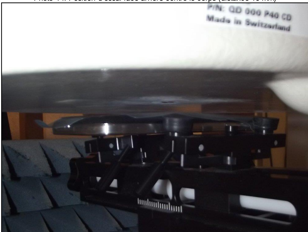
Photo 14: Position d'essai face arrière contre le corps (distance 10 mm)
