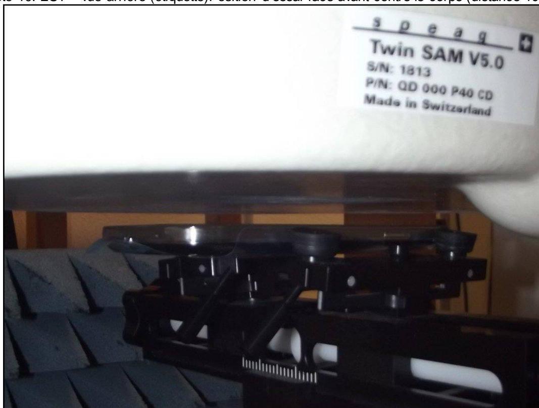
Photo 10: EST – vue arrière (étiquette) Position d'essai face avant contre le corps (distance 10 mm)
