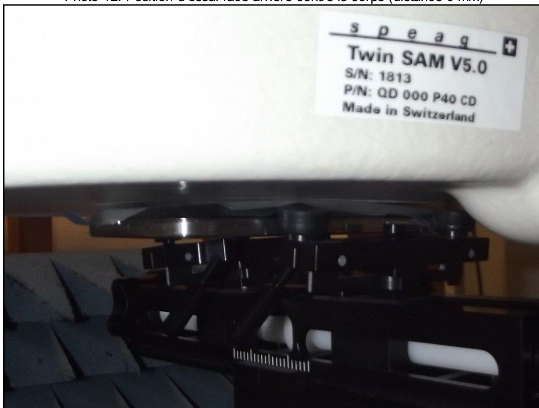
Photo 12: Position d'essai face arrière contre le corps (distance 0 mm)
