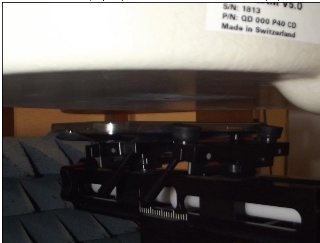
Photo 12: Position d'essai face arrière contre le corps (distance 0 mm)
