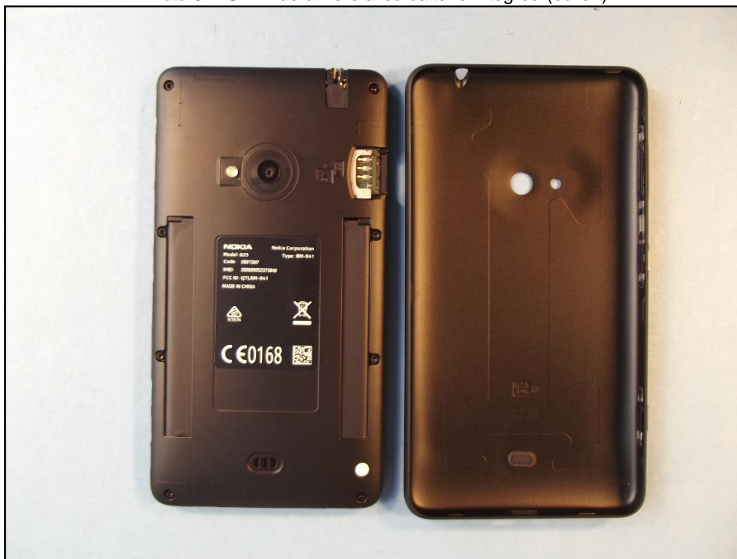
Photo 5: EST – vue arrière avec batterie intégrée (ouvert)
