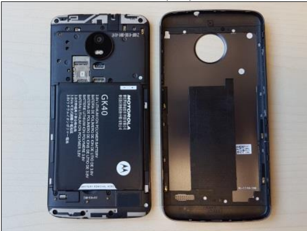
Photo 5: EST – vue arrière (ouvert) avec batterie
