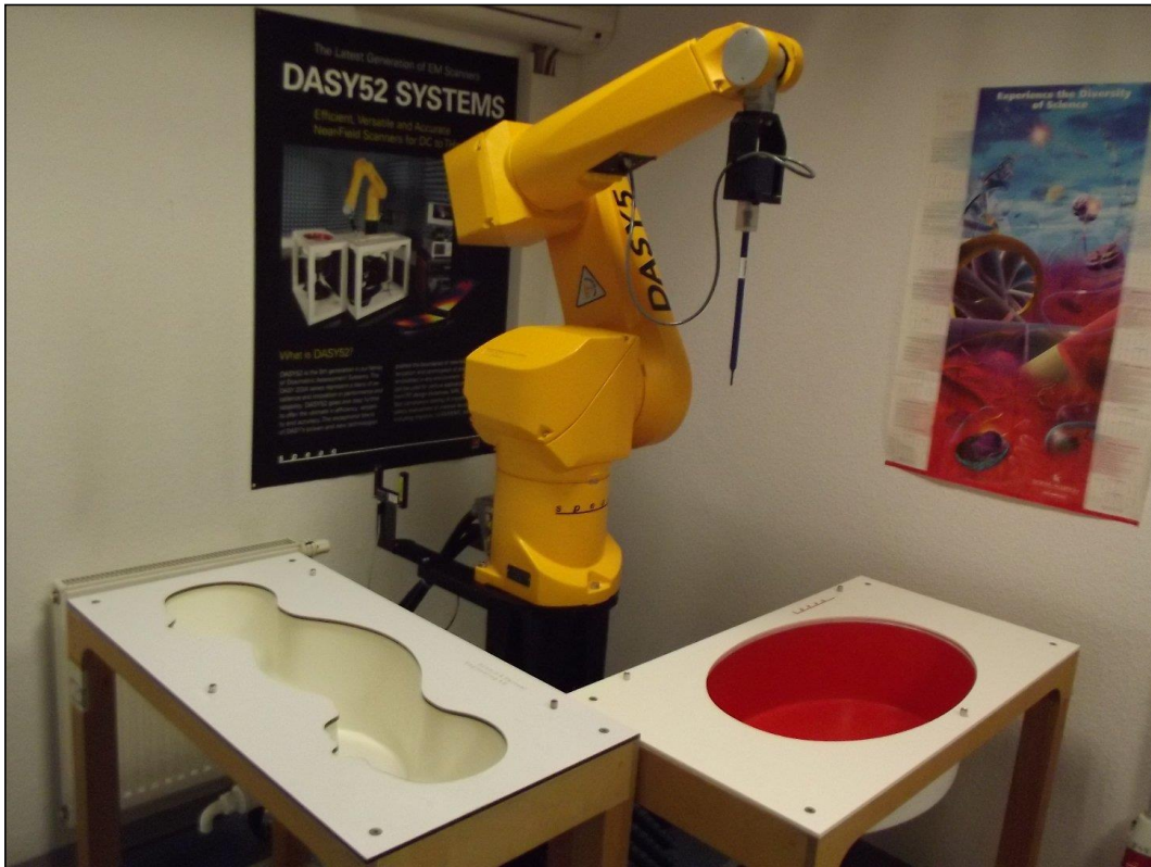
Photo 1: Banc d'essai DASY 5
