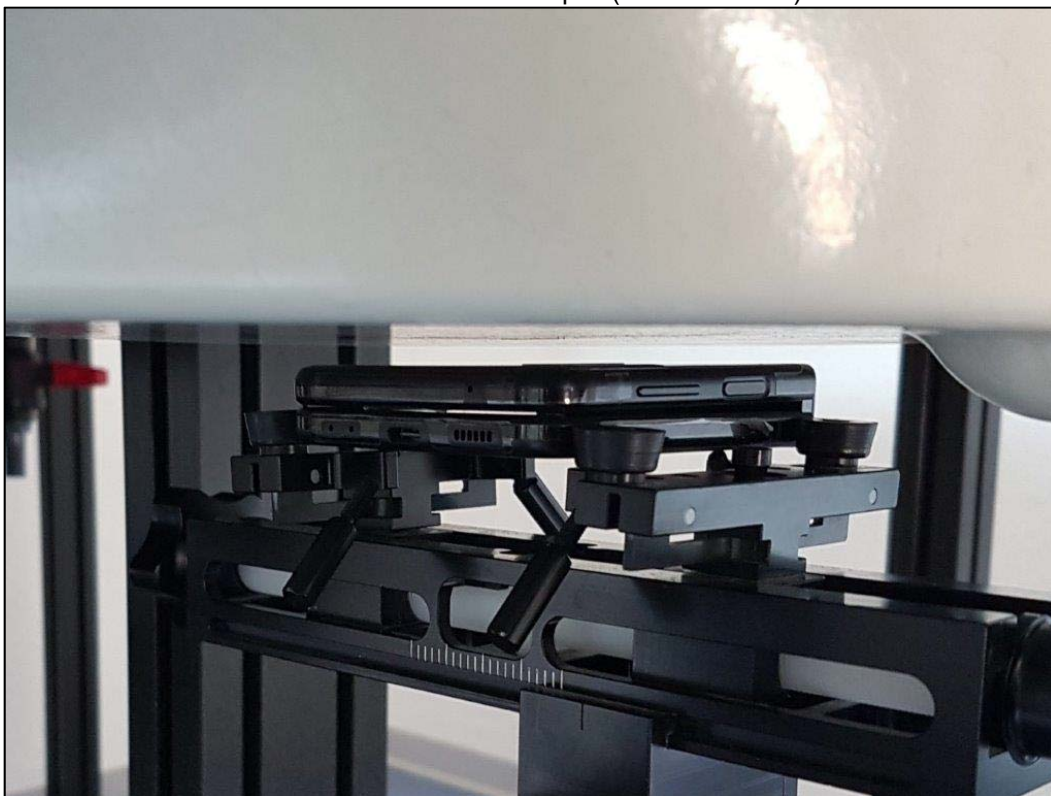
Photo 14: Position arrière plié (distance 5 mm)
