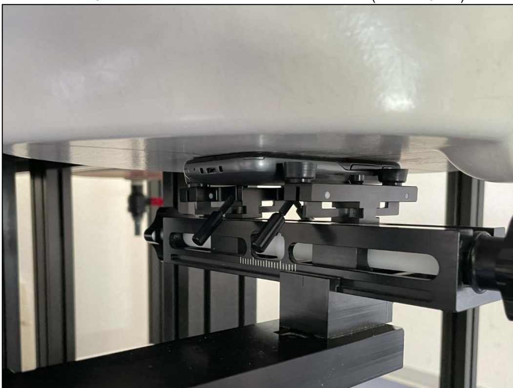
Photo 9: Position d'essai face arrière contre le membre (distance 0 mm)
