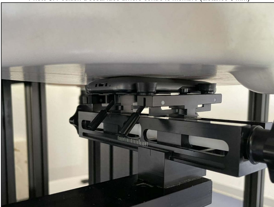
Photo 9: Position d'essai face arrière contre le membre (distance 0 mm)
