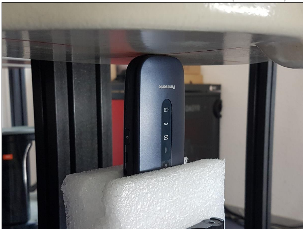
Photo 14: Position d'essai face du dessous contre le membre (distance 0 mm)
