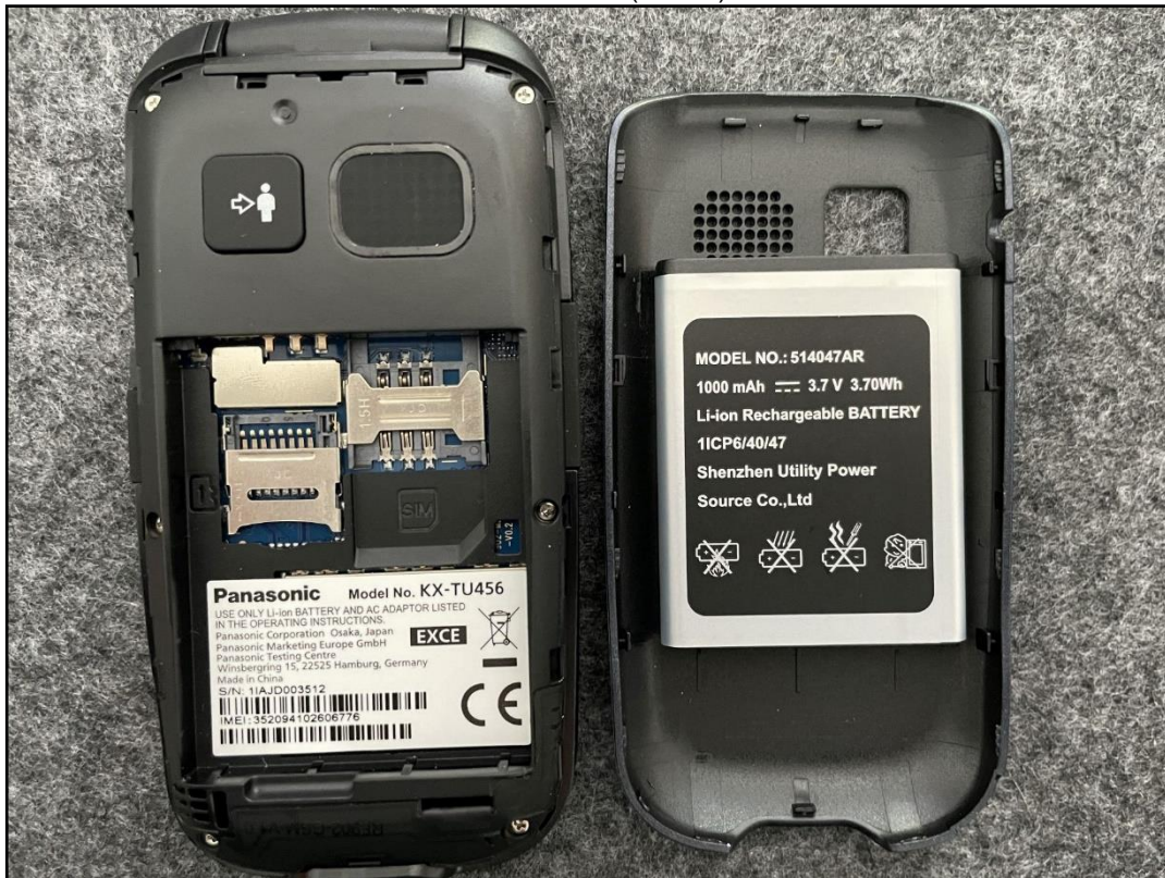
Photo 7: EST – vue arrière (ouvert) sans batterie
