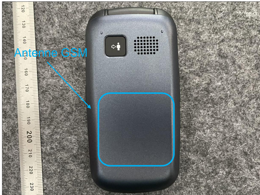
Photo 6: EST – vue arrière (ouvert) avec batterie
