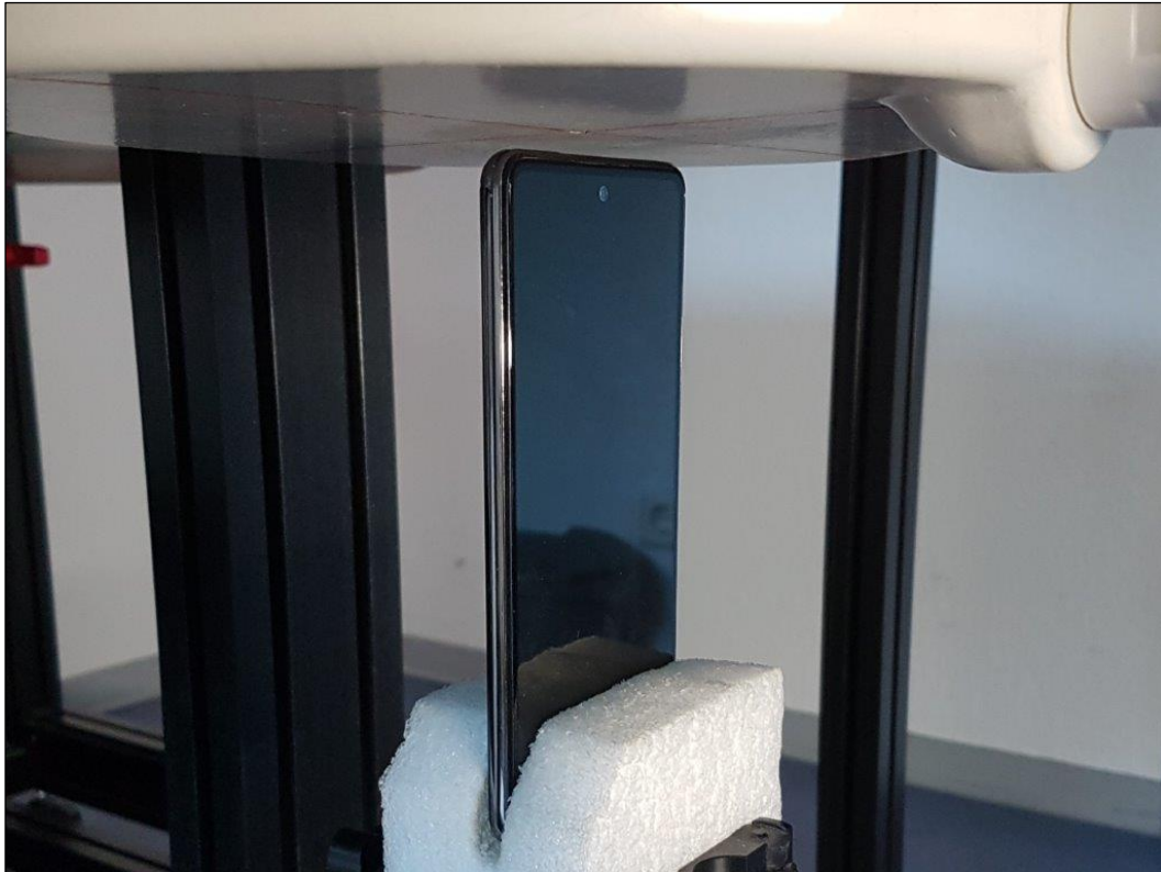
Photo 12: Position d'essai face du dessous contre le corps (distance 5 mm)
