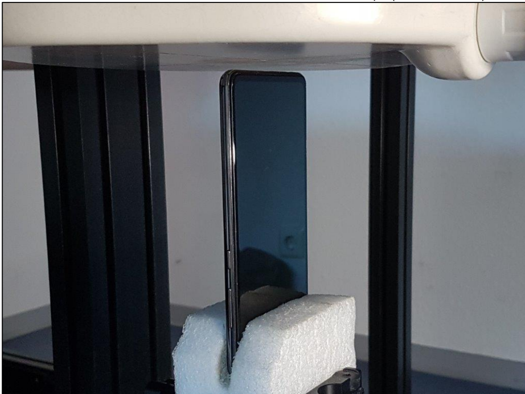
Photo 12: Position d'essai face du dessous contre le corps (distance 5 mm)
