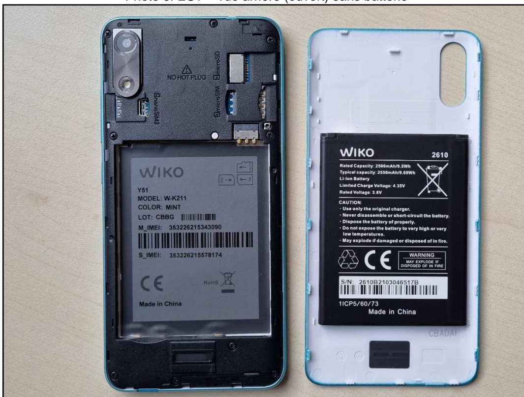
Photo 6: EST – vue arrière (ouvert) sans batterie
