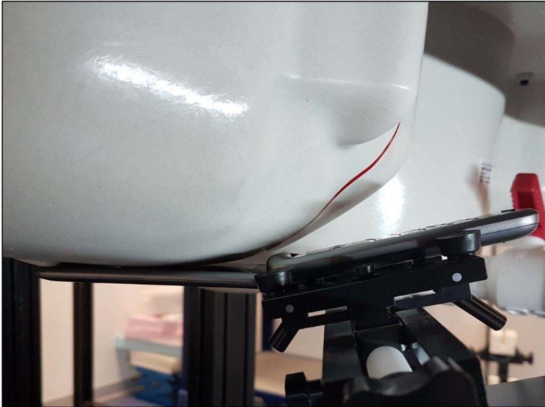
Photo 16: Position d'essai main droite, contre la joue
