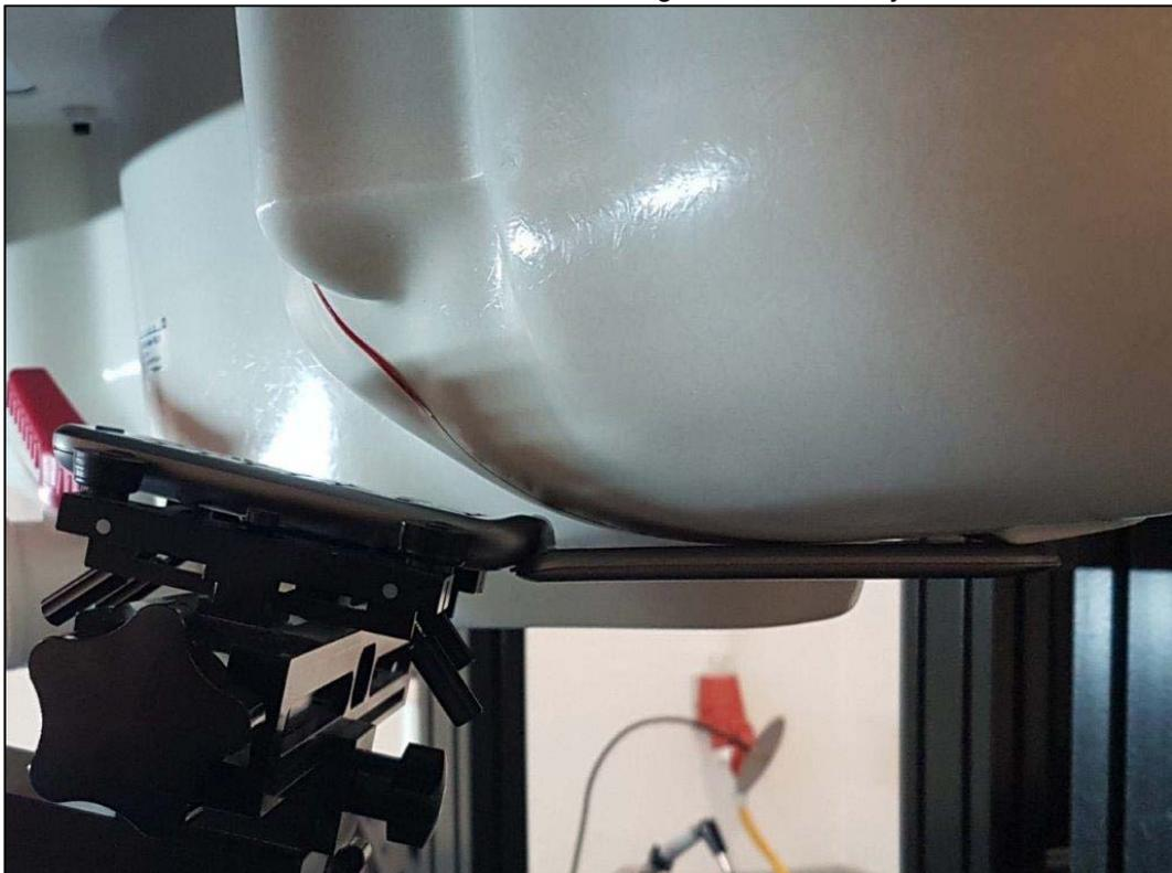
Photo 11: Position d'essai main gauche, contre la joue
