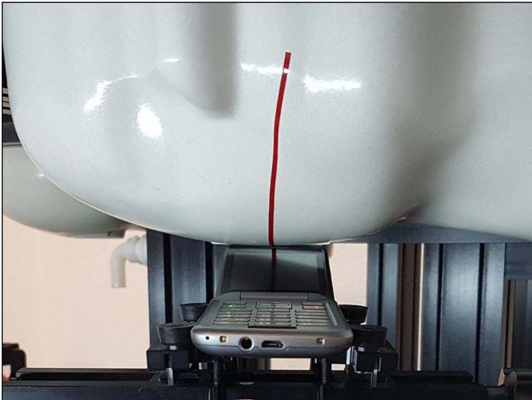
Photo 18: Position d'essai main droite, incliné 15°
