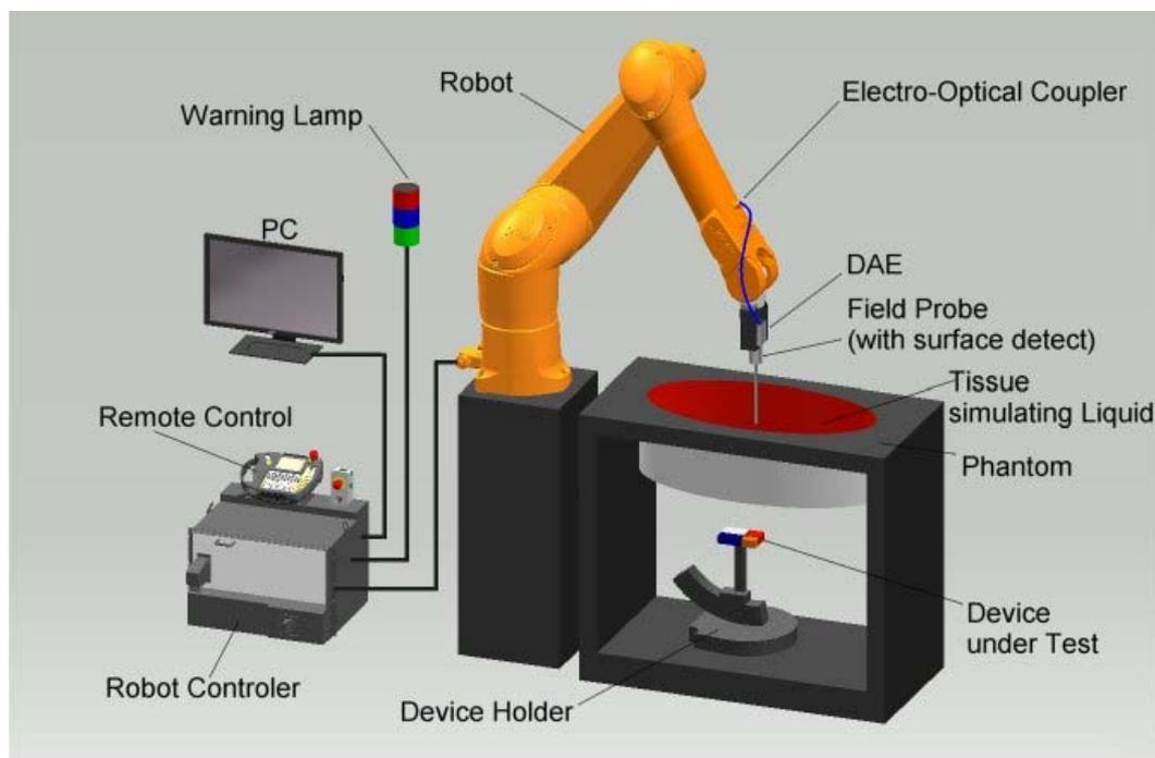
Le système DAS utilisé pour les essais de conformité comprend les éléments suivants :
