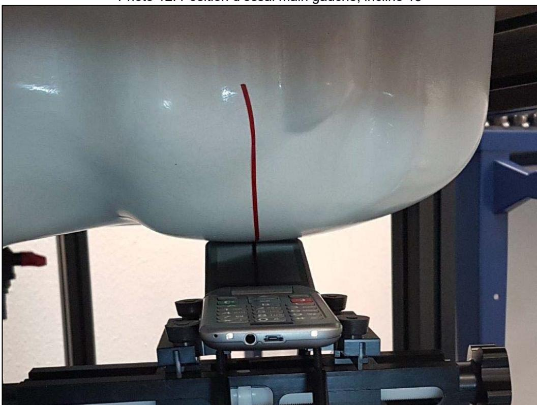
Photo 13: Position d'essai main gauche, incliné 15°
