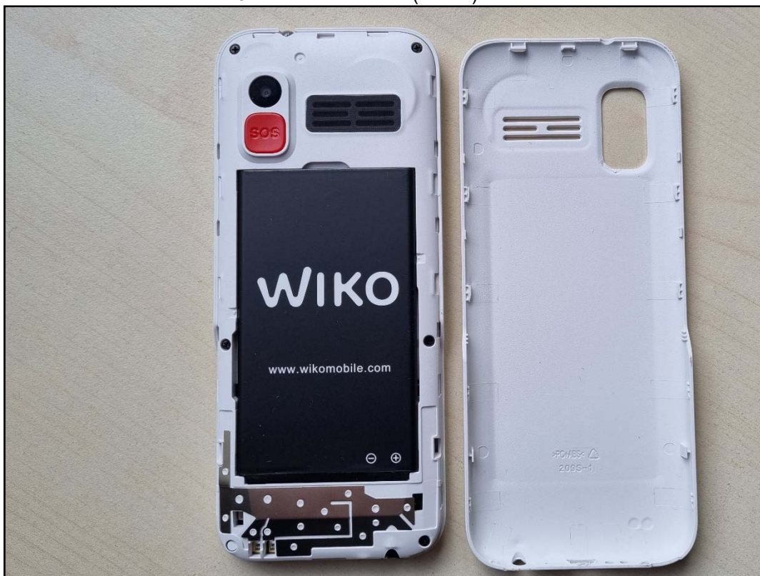
Photo 5: EST – vue arrière (ouvert) avec batterie
