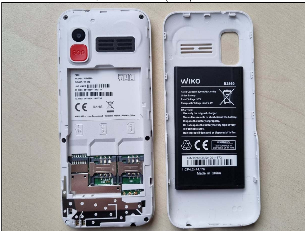
Photo 6: EST – vue arrière (ouvert) sans batterie
