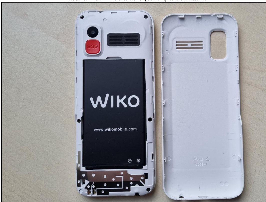
Photo 5: EST – vue arrière (ouvert) avec batterie
