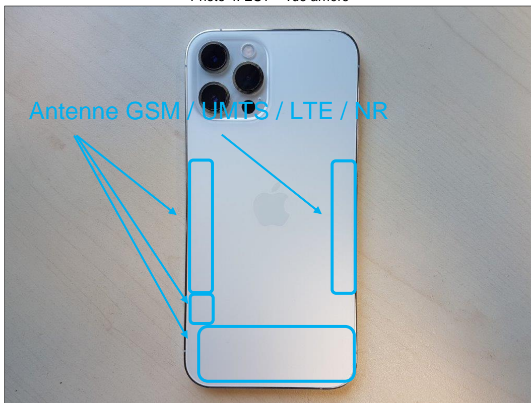
Photo 4: EST – vue arrière
