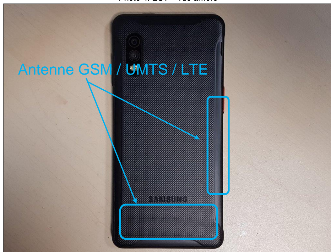
Photo 4: EST – vue arrière
