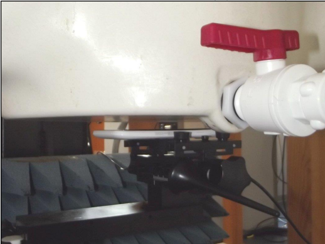
Photo 8: Position d'essai face avant contre le corps (distance 10 mm)
