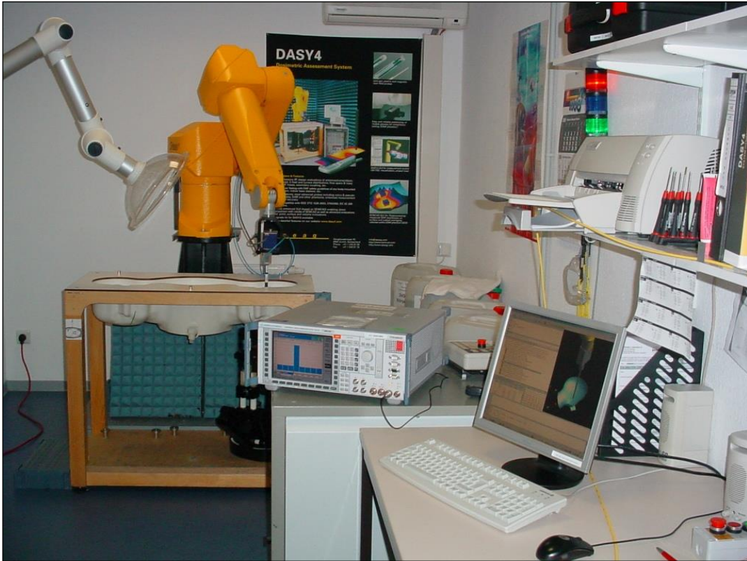
Photo 1: Banc d'essai DASY 5
