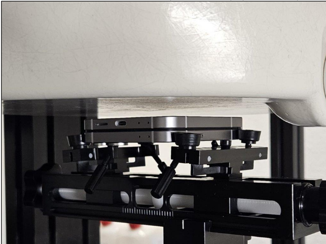
Photo 14: Position d'essai face arrière pilé contre le corps (distance 5 mm)
