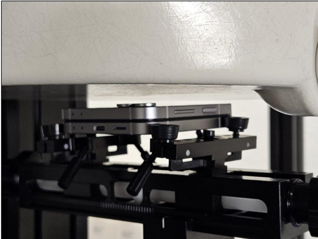
Photo 13: Position d'essai face avant pilé contre le corps (distance 5 mm)
