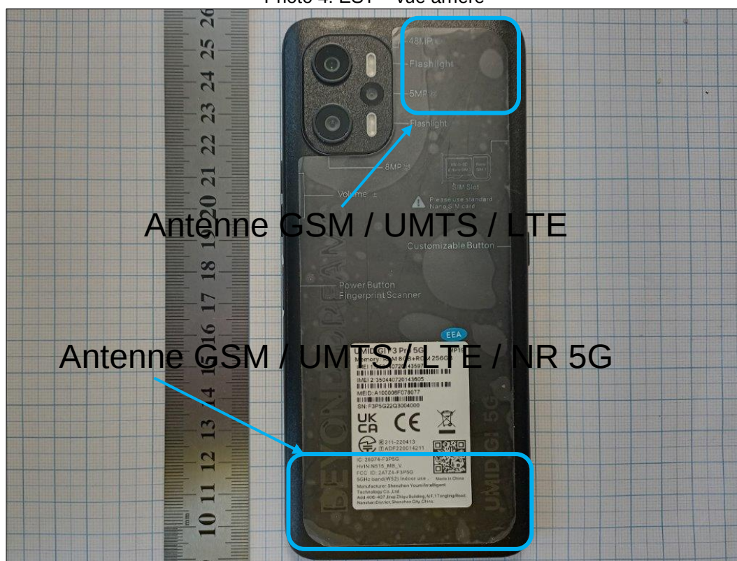
Photo 4: EST – vue arrière
