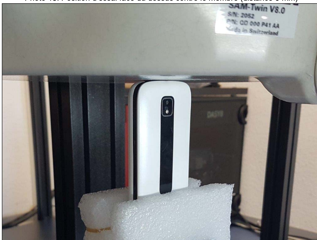
Photo 16: Position d'essai face du dessous contre le membre (distance 0 mm)
