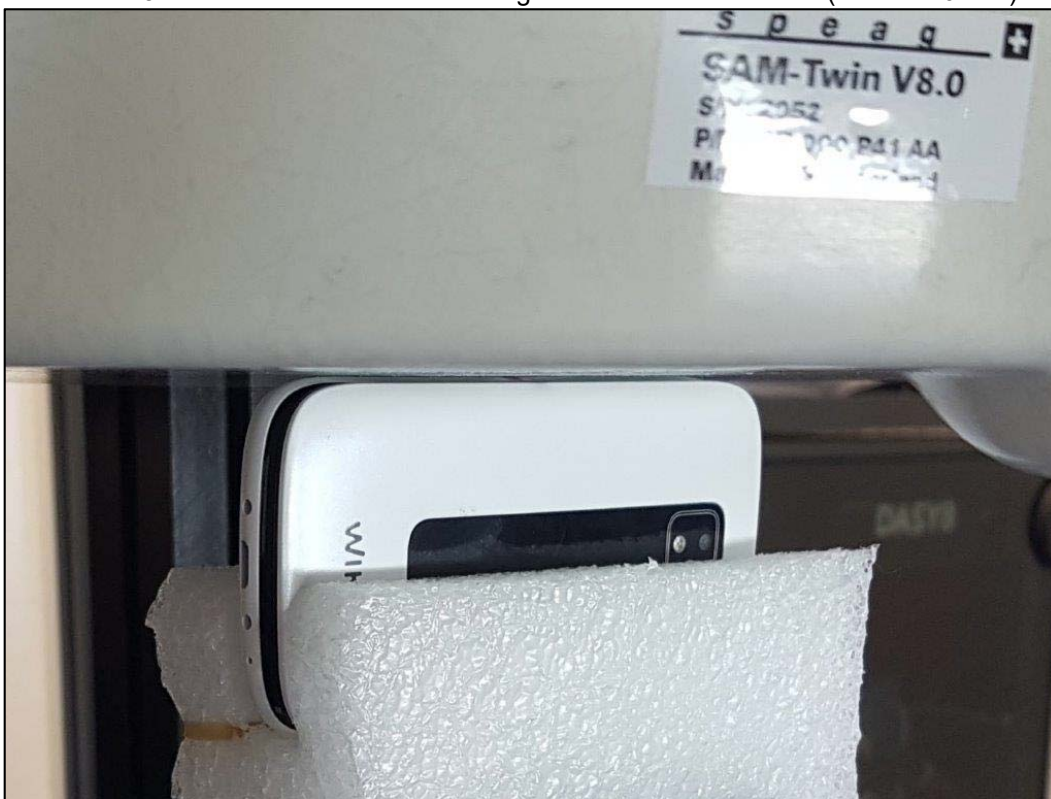
Photo 14: Position d'essai face du côté droite contre le membre (distance 0 mm)
