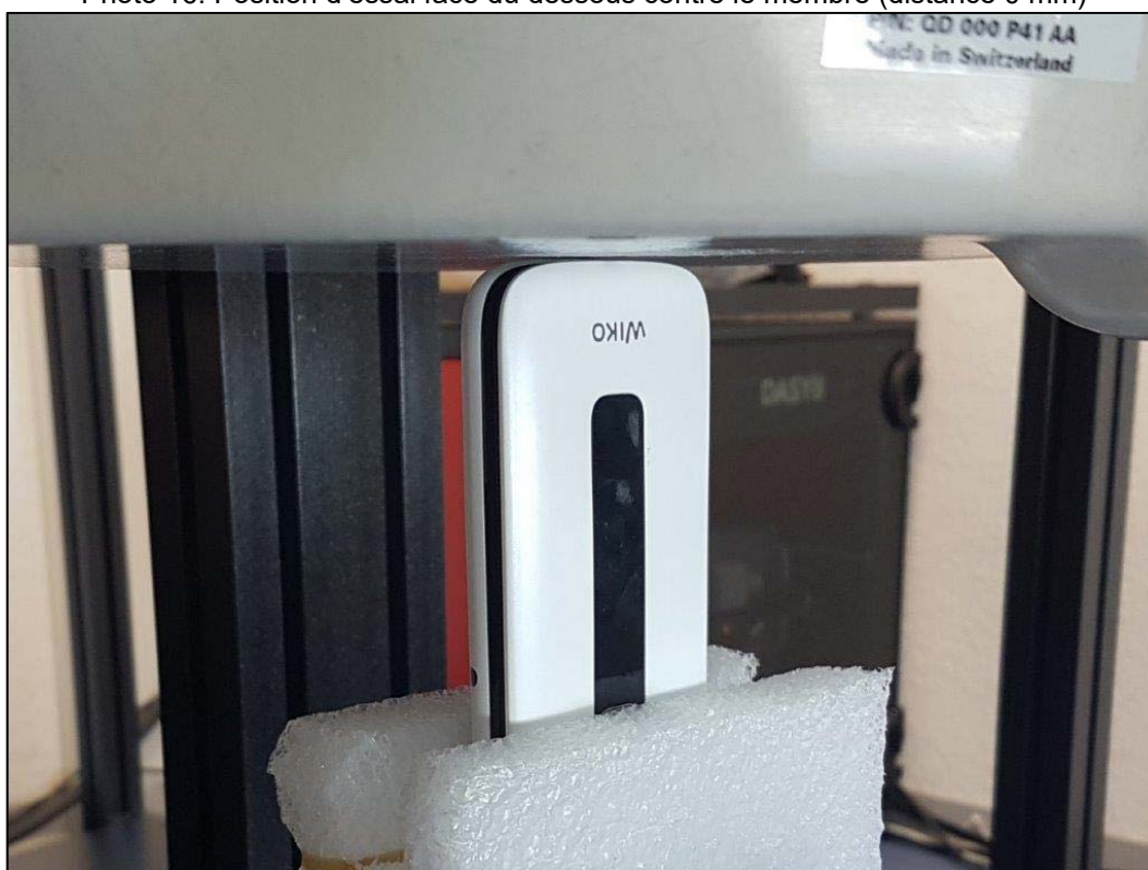
Photo 16: Position d'essai face du dessous contre le membre (distance 0 mm)
