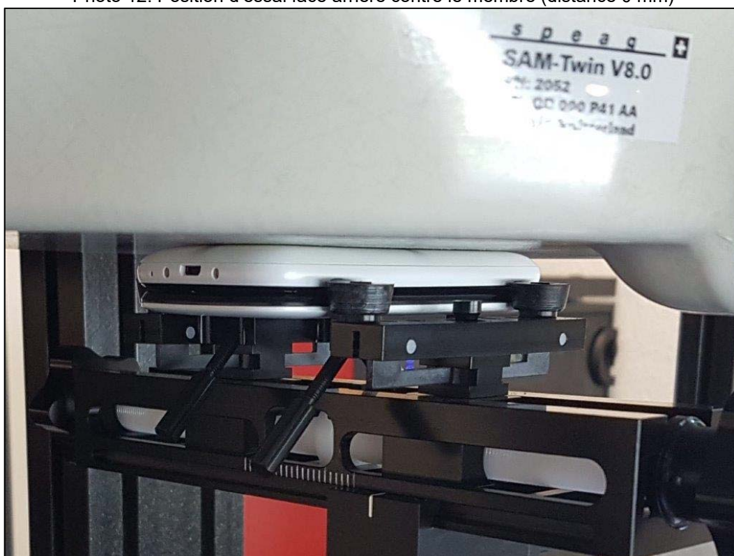
Photo 12: Position d'essai face arrière contre le membre (distance 0 mm)
