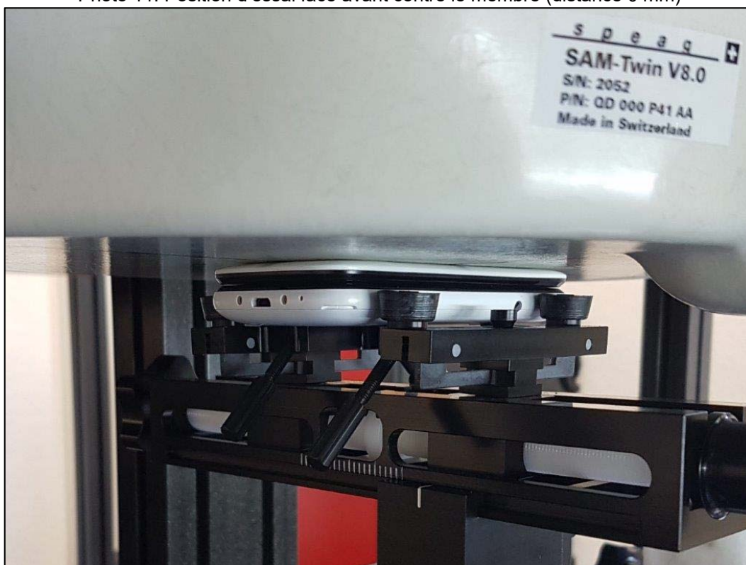
Photo 12: Position d'essai face arrière contre le membre (distance 0 mm)
