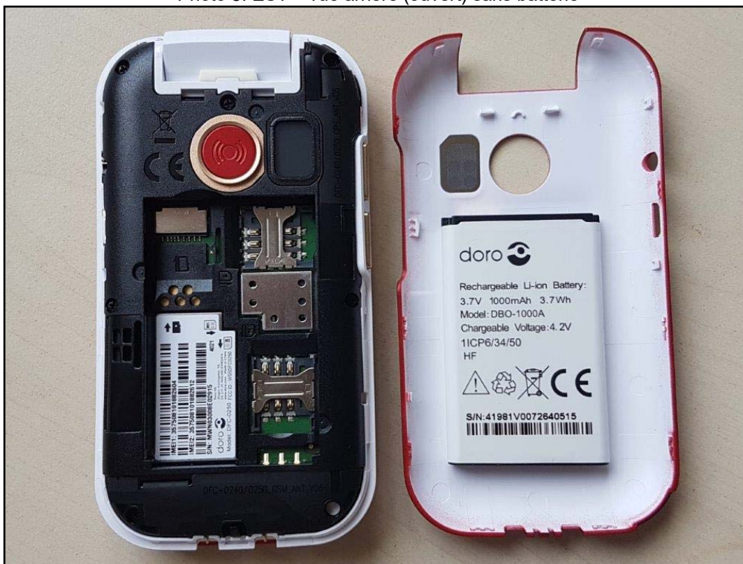
Photo 8: EST – vue arrière (ouvert) sans batterie
