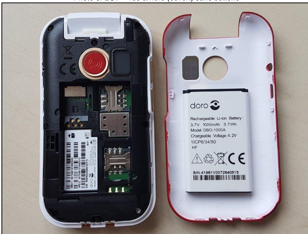
Photo 6: EST – vue arrière (ouvert) sans batterie
