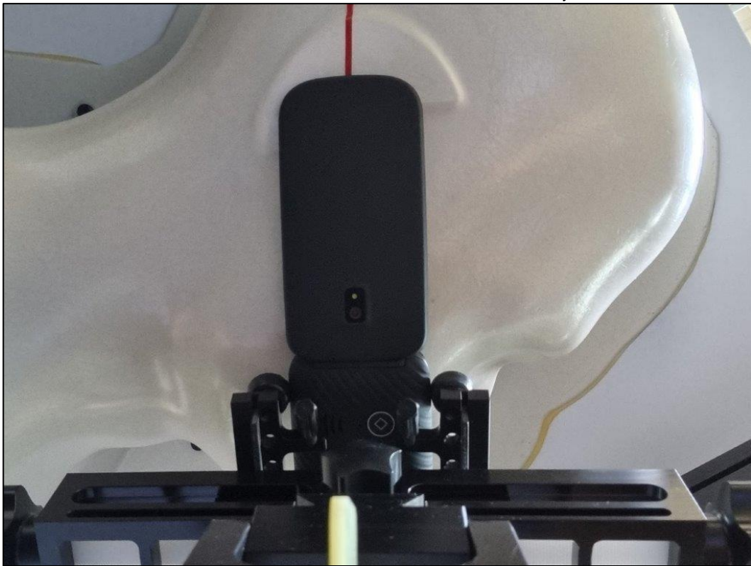
Photo 18: Position d'essai main droite, incliné 15°
