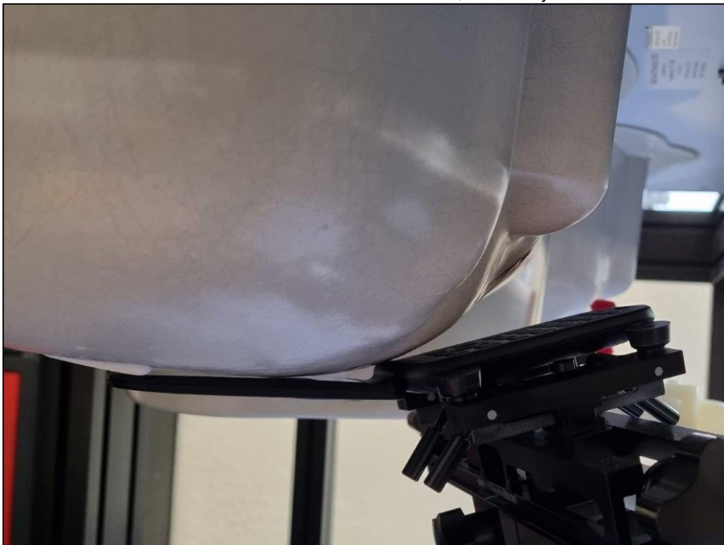
Photo 16: Position d'essai main droite, contre la joue
