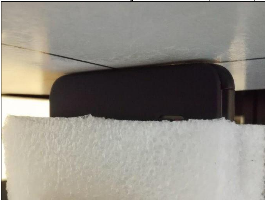
Photo 14: Position d'essai face du côté droite contre le membre (distance 0 mm)
