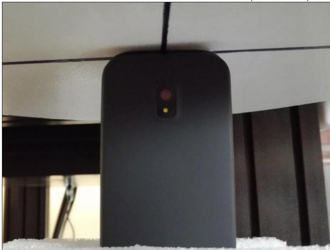
Photo 15: Position d'essai face du dessus contre le membre (distance 0 mm)
