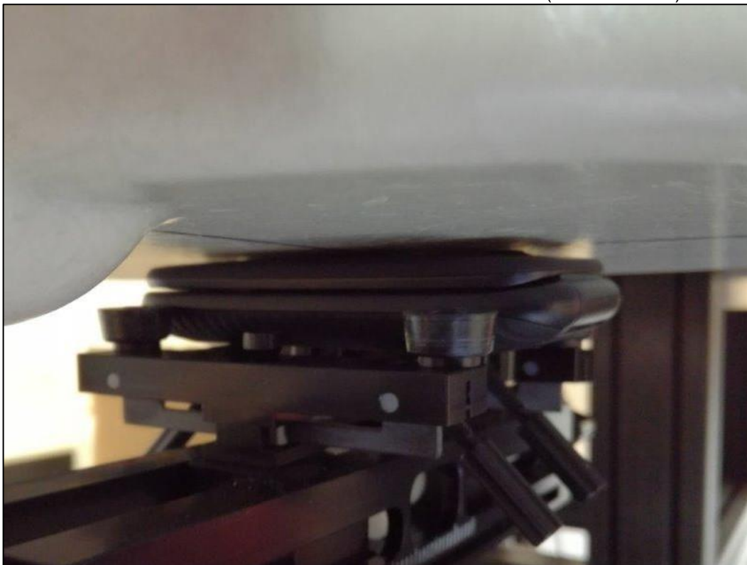
Photo 11: Position d'essai face avant contre le membre (distance 0 mm)
