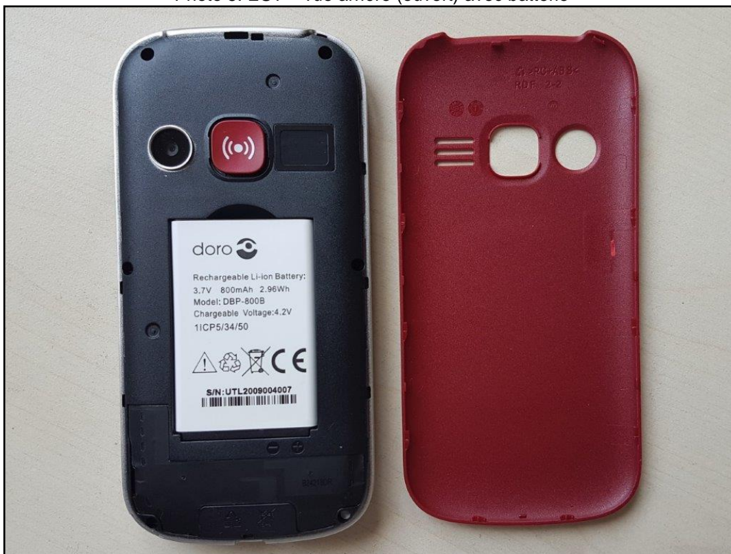
Photo 5: EST – vue arrière (ouvert) avec batterie
