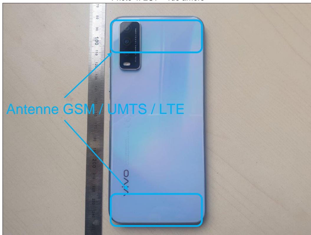
Photo 4: EST – vue arrière
