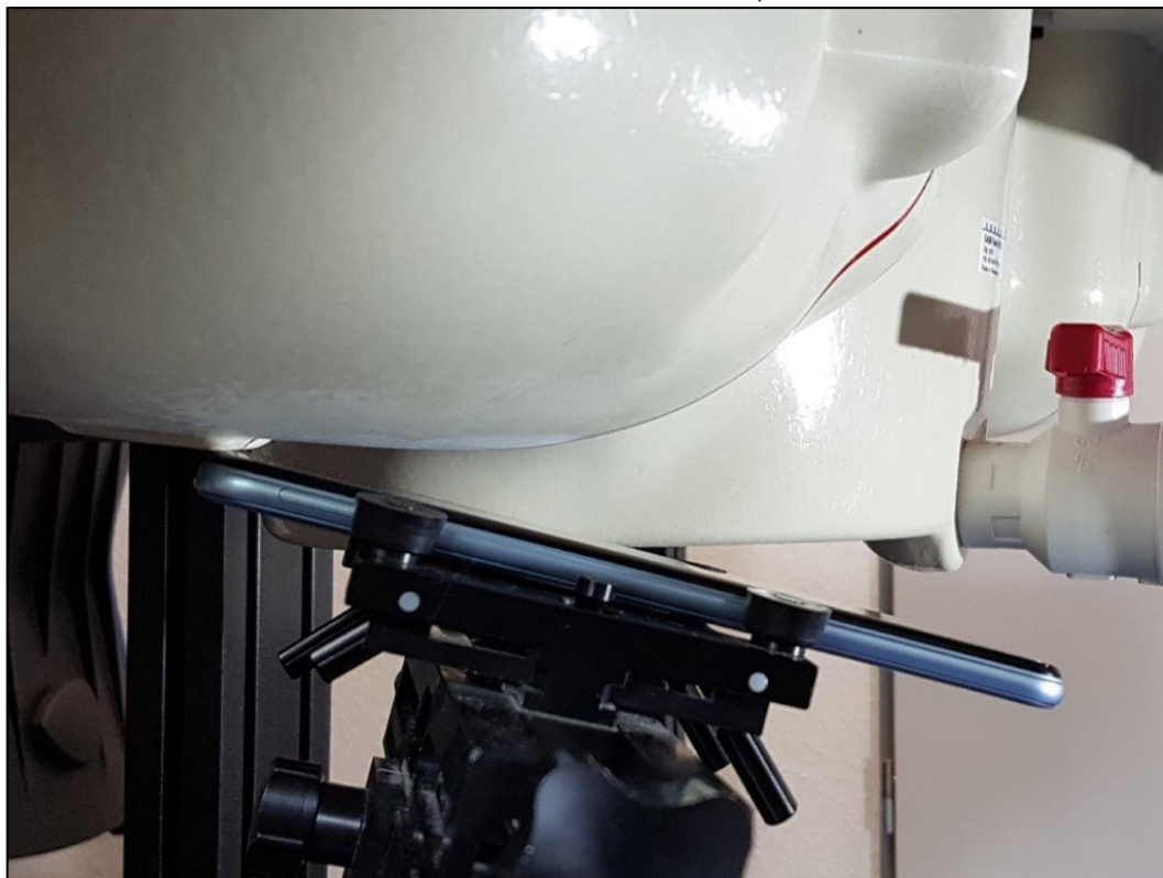
Photo 15: Position d'essai main droite, incliné 15°
