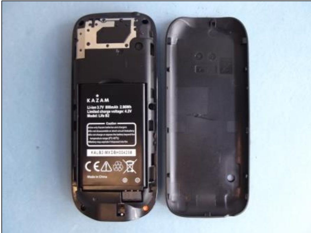
Photo 5: EST – vue arrière (ouvert) avec batterie
