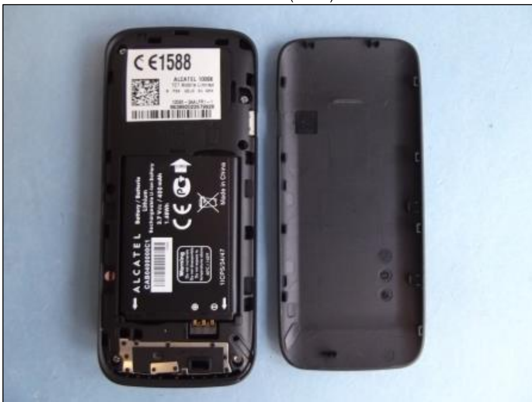
Photo 5: EST – vue arrière (ouvert) avec batterie
