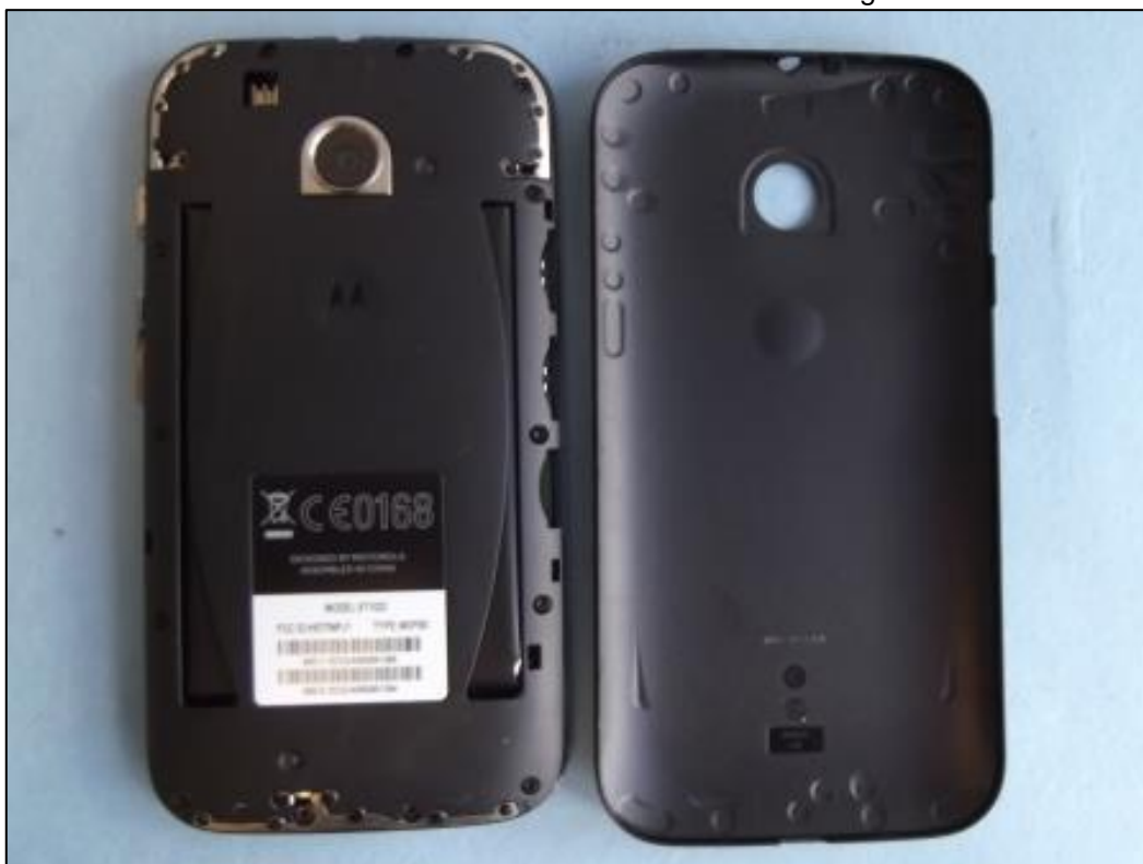
Photo 5: EST – vue arrière ouvert – batterie intégrée
